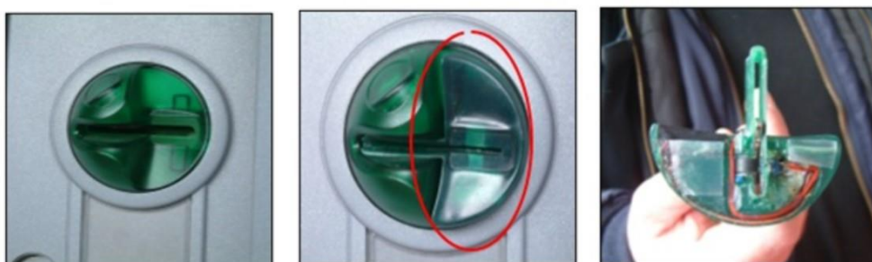
Obrázek 5: Skimmovací nástavec v otvoru bankomatu typu NCR
