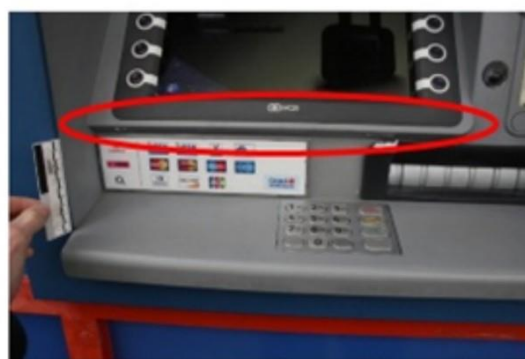
Obrázek 6: Minikamery, nainstalované v bankomatech
