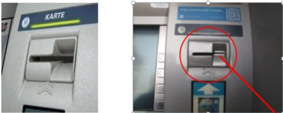
Obrázek 4: Skimmovací nástavec v otvoru bankomatu typu WN
