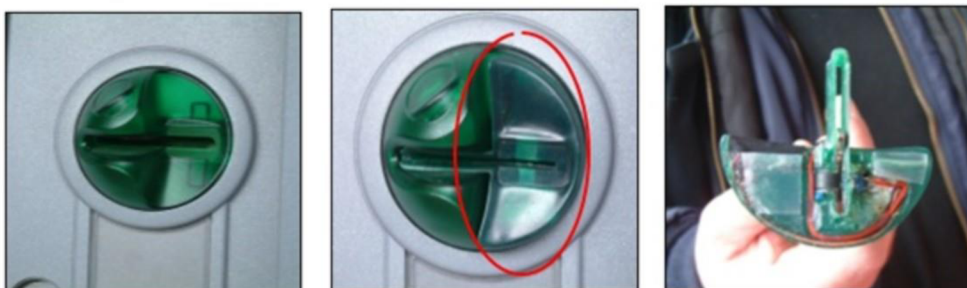
Obrázek 5: Skimmovací nástavec v otvoru bankomatu typu NCR
