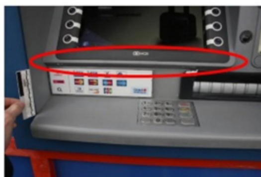
Obrázek 6: Minikamery, nainstalované v bankomatech
