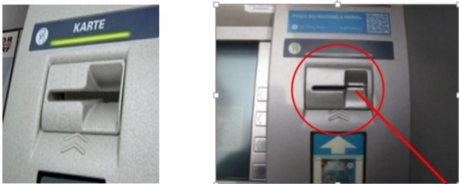
Obrázek 4: Skimmovací nástavec v otvoru bankomatu typu WN
