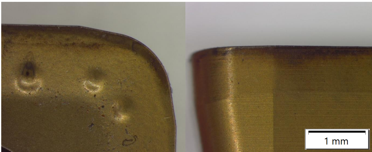
Obr. 52 Opotřebení destičky SOHT 09, vlevo čelo, vpravo hlavní hřbet.
