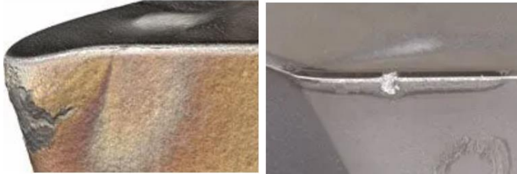
Obr. 11 Vlevo plastická deformace, vpravo křehký lom břitu [18].
