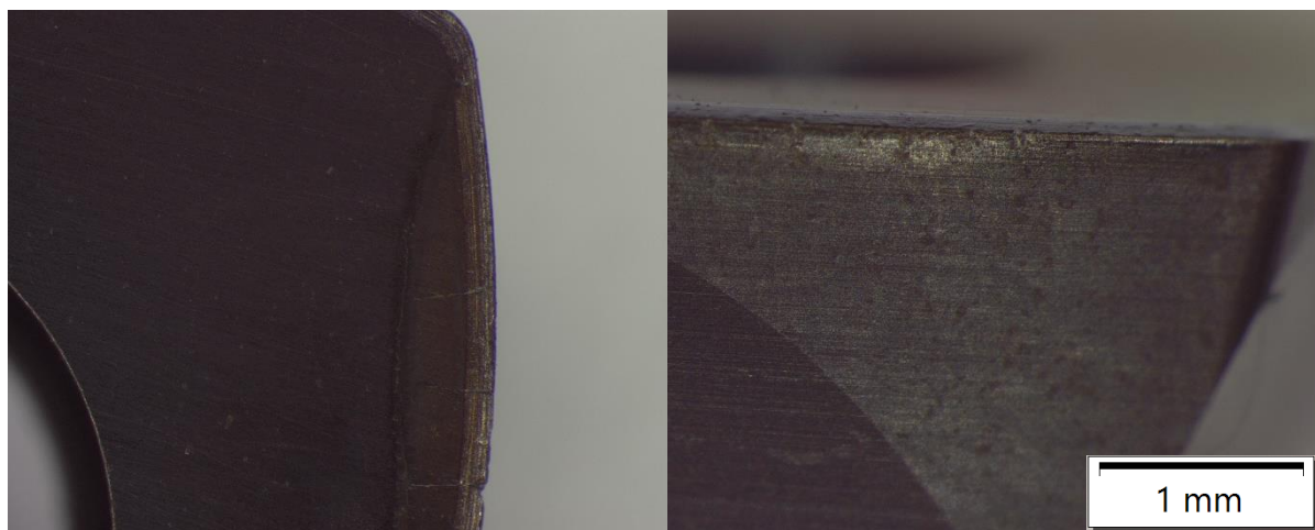
Obr. 51 Opotřebení destičky ZDEW 09, vlevo čelo, vpravo hlavní hřbet.
