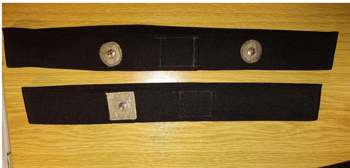
Obrázek 4.3 První prototyp měřicího pásu (malé kulaté elektrody)
