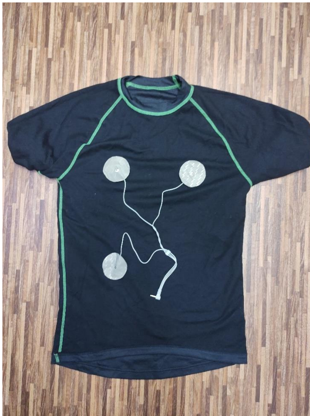
Obrázek 5.12 Rozmístění elektrod na měřicím triku
