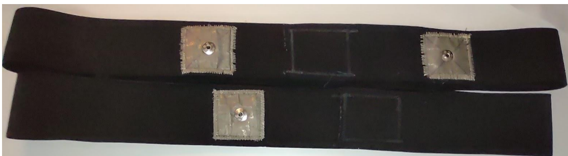
Obrázek 4.5 Druhý prototyp měřícího pásu (čtvercové elektrody)
