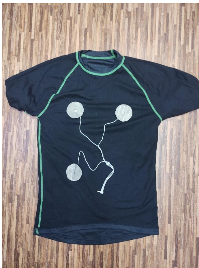
Obrázek 4.1 Rozmístění elektrod na měřícím triku
