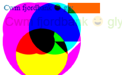
Obrázek 6.2: Výsledný obrázek po aplikaci všech technik skriptem FingerprintJS, který je použit pro získání informací.
