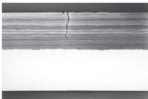
Obr. 17: Ukázka praskliny způsobená korozi účinkem mořského vzduchu.[2]
