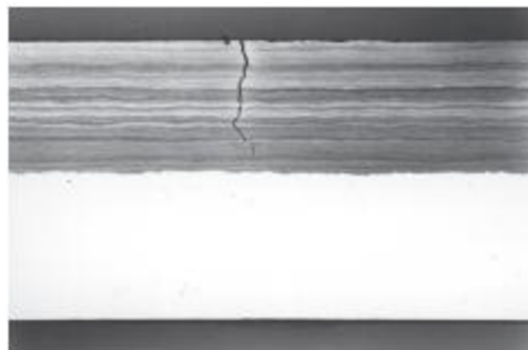
Obr. 17: Ukázka praskliny způsobená korozi účinkem mořského vzduchu.[2]
