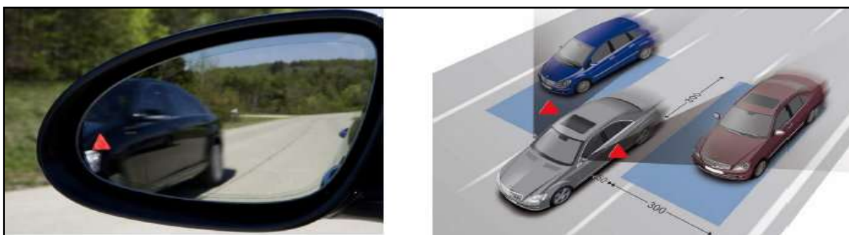
Obr. č. 63 – Radarový systém monitoringu mrtvých úhlů (21)
