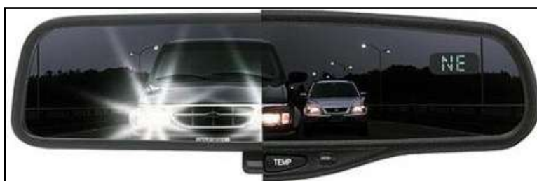
Obr. č. 44 – Rozdíl běžného a automaticky zaclonitelného zpětného zrcátka (30)
