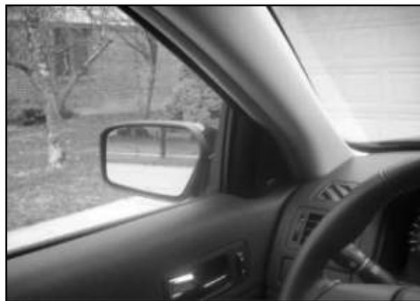
Obr. č. 82 – Pohled na A–sloupek pravým okem (3)
