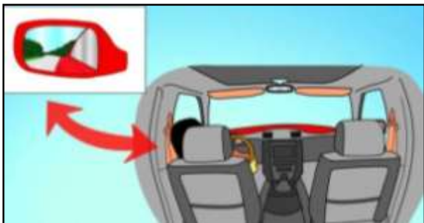
Obr. č. 52 – Nastavení levého zpětného zrcátka (34)
