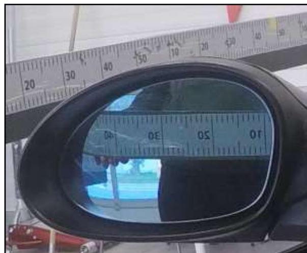
Obr. č. 109 – Detail měřky ve vnějším zpětném zrcátku zobrazující 43cm (autor)
