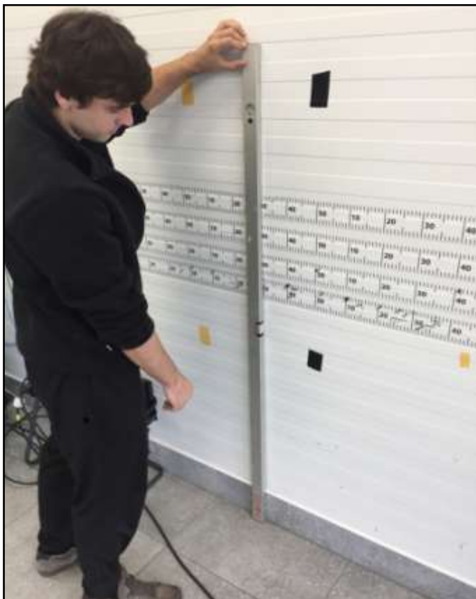
Obr. č. 98 – Způsob přenesení naměřené délky na vodorovnou rovinu (autor)
