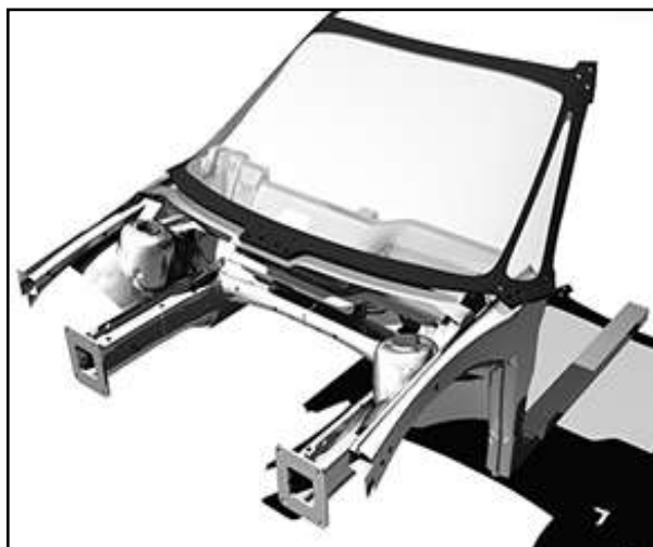
Obr. č. 33 – Konstrukce připevněná k platformě vozidla (10)
