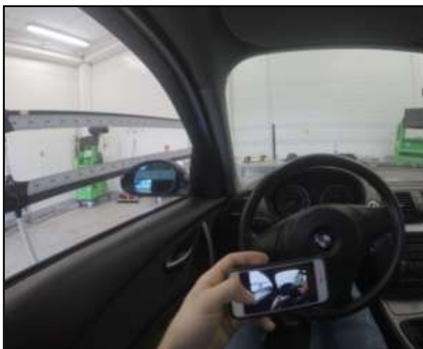
Obr. č. 108 – Způsob měření vnějších zpětných zrcátek (autor)
