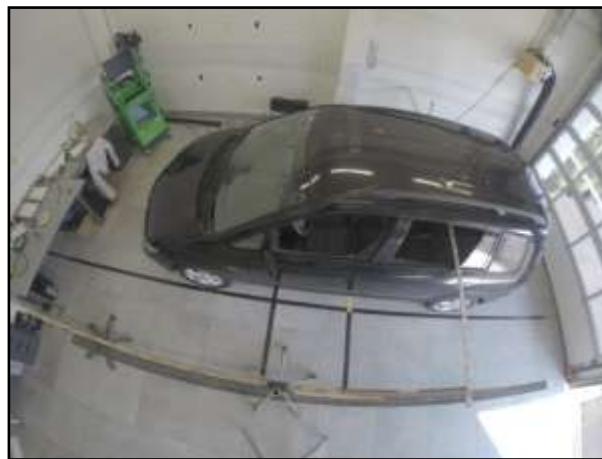
Obr. č. 89 – Připravený prostor laboratoře měření s pozicí vozidla dle najížděcího pásu a pásu pozice zrcátek (autor)
