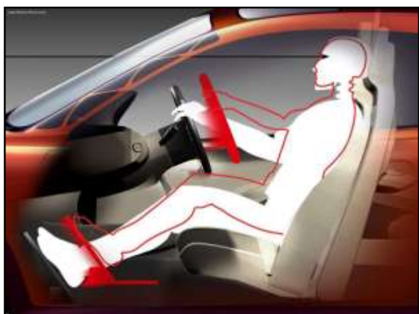
Obr. č. 28 – Možné seřízení řídicích prvku pro ideální výhled z vozidla Volvo SCC (13)
