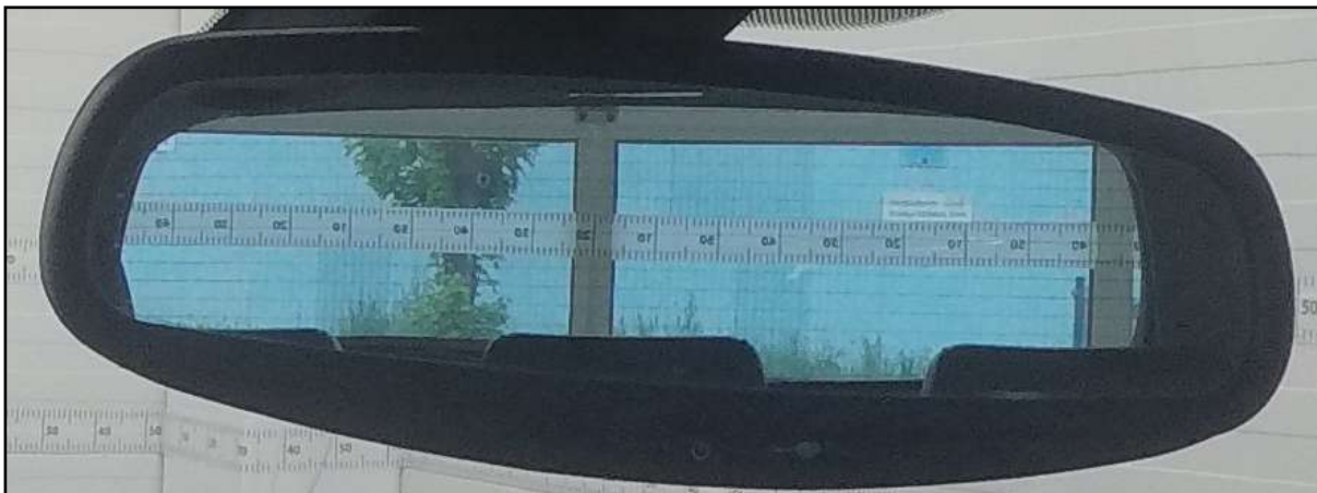
Obr. č. 105 – Metrická měřka ve zpětném zrcátku zobrazující zabíraný rozměr 167cm z metrické pásky za vozidlem (autor)
