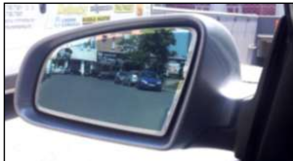
Obr. č. 51 – Zrcátko vybavené automatickým zacloňováním aktivované (33)
