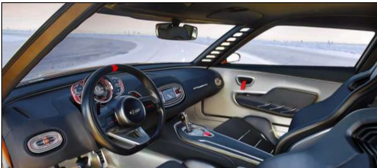
Obr. č. 30 – Průhledný A–sloupek vozidla Kia Stinger GT4 (13)
