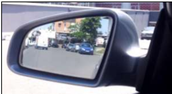
Obr. č. 50 – Zrcátko vybavené automatickým zacloňováním před aktivací (33)
