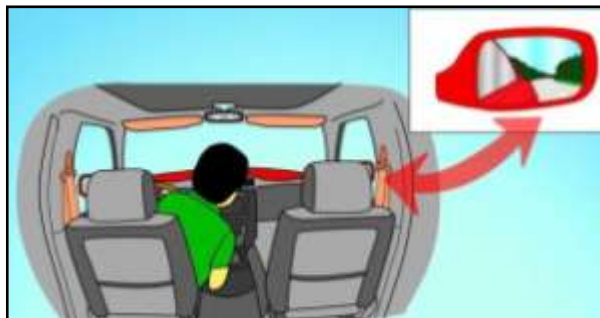
Obr. č. 53 – Nastavení pravého zpětného zrcátka (34)
