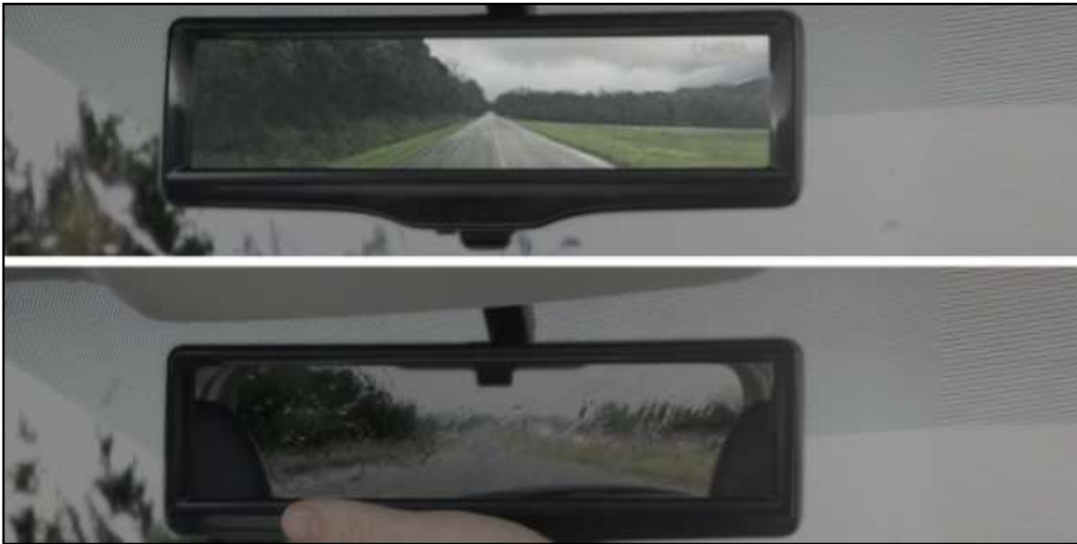
Obr. č. 61 – Srovnání běžného interiérového zpětného zrcátka a chytrého zpětného zrcátka (38)
