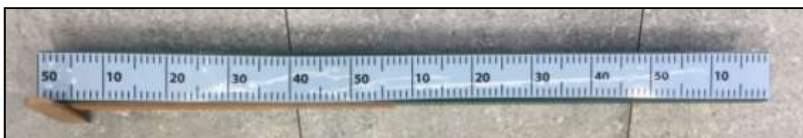
Obr. č. 97 – Kolmý příložník s metrickou měrkou (autor)
