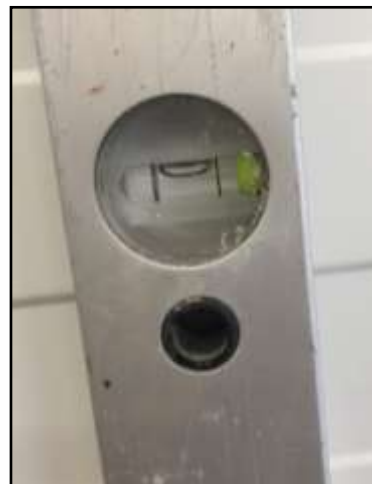
Obr. č. 99 – Měrka (bublínka) vodováhy vyznačující kolmost k podložce (autor)
