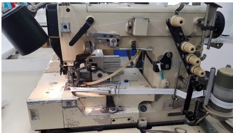
Obrázek 41: Stroj na lemování páskou
