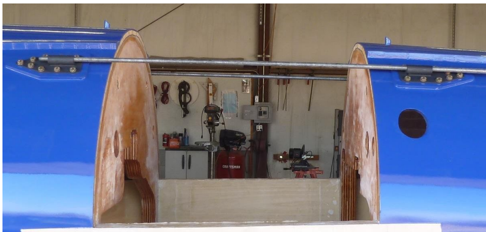
Obrázek 2.14: Výřez v trupu (spodní stranou nahoru) letounu Bugatti 100P
