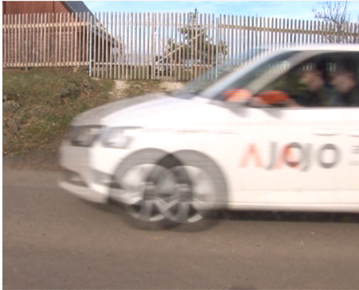
Obrázek 3 - Prokládaný snímek zobrazený na progresivním displeji [vlastní]
