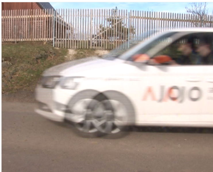
Obrázek 3 - Prokládaný snímek zobrazený na progresivním displeji [vlastní]
