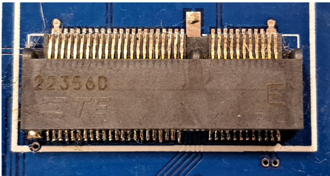
Obr. 3.6: Zbernica M.2 key E na BPC-IOT doske
