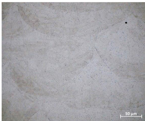
Obr. 5.16 Mikrostruktura vzorku SLM H70 na SM, zvětšeno 500x.
