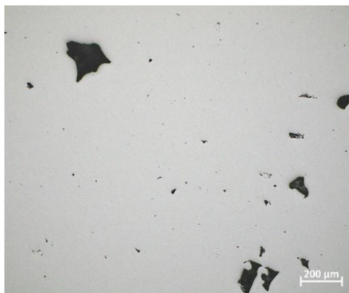
Obr. 5.6 Pórovitost vzorku SLM H50 na SM, zvětšeno 10x.
