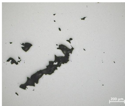
Obr. 5.9 Nebezpečný pór ve vzorku SLM H50 na SM, zvětšeno 10x.
