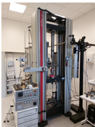
Obr. 4.13 Zařízení pro zkoušku v ohybu ZWICK/ROELL Z250.
