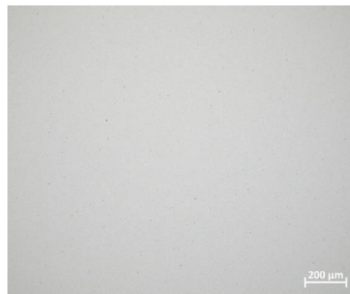
Obr. 5.7 Pórovitost vzorku SLM R50 na SM, zvětšeno 10x.
