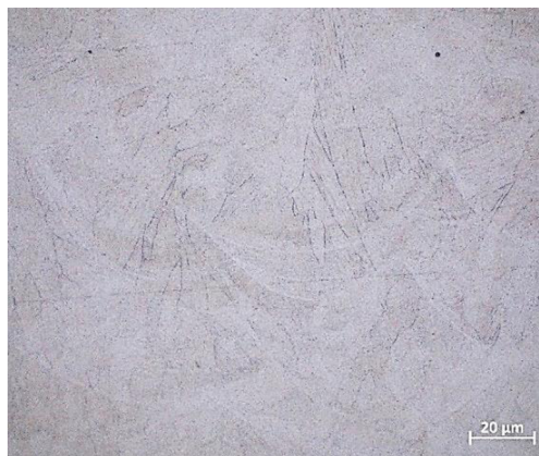
Obr. 5.19 Mikrostruktura vzorku SLM H50 na SM, zvětšeno 1000x.
