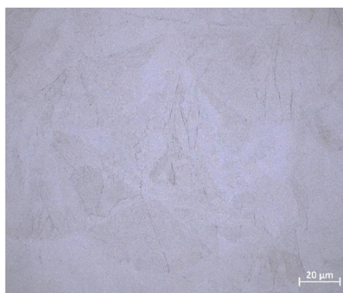
Obr. 5.21 Mikrostruktura vzorku SLM R50 na SM, zvětšeno 1000x.
