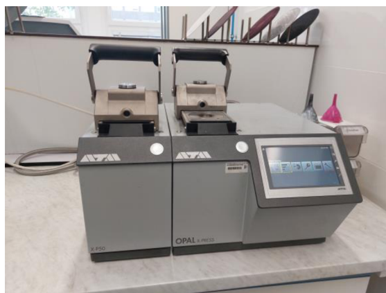
Obr. 4.7 Lisovací zařízení ATM Opal Xpress.
