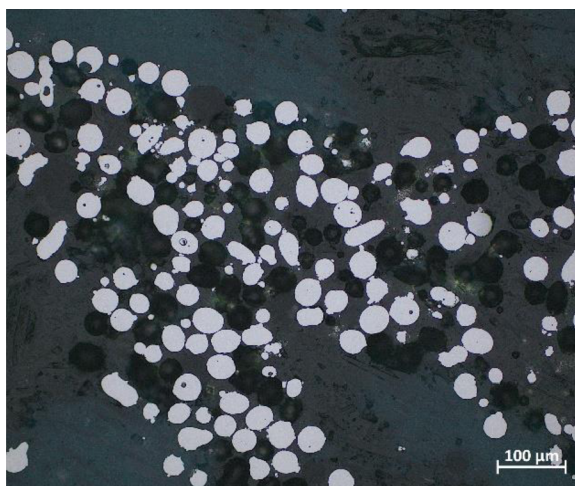
Obr. 4.1 Metalurgický výbrus použitého prášku, SM.
