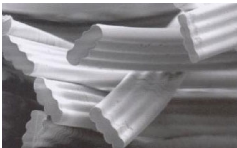
Obrázek 9 Průřez vláknem Coolmax® s šesti kanálky (9)
