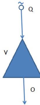
Obr. 1. Schéma nádrže (Kozel, 2017)
