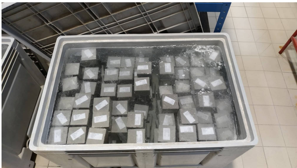
Obr. 10 Uložení zkušebních krychlí do vody
