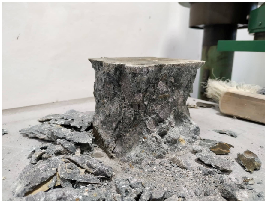
Obr. 11 správná deformace krychle po pomačkání na lisu
