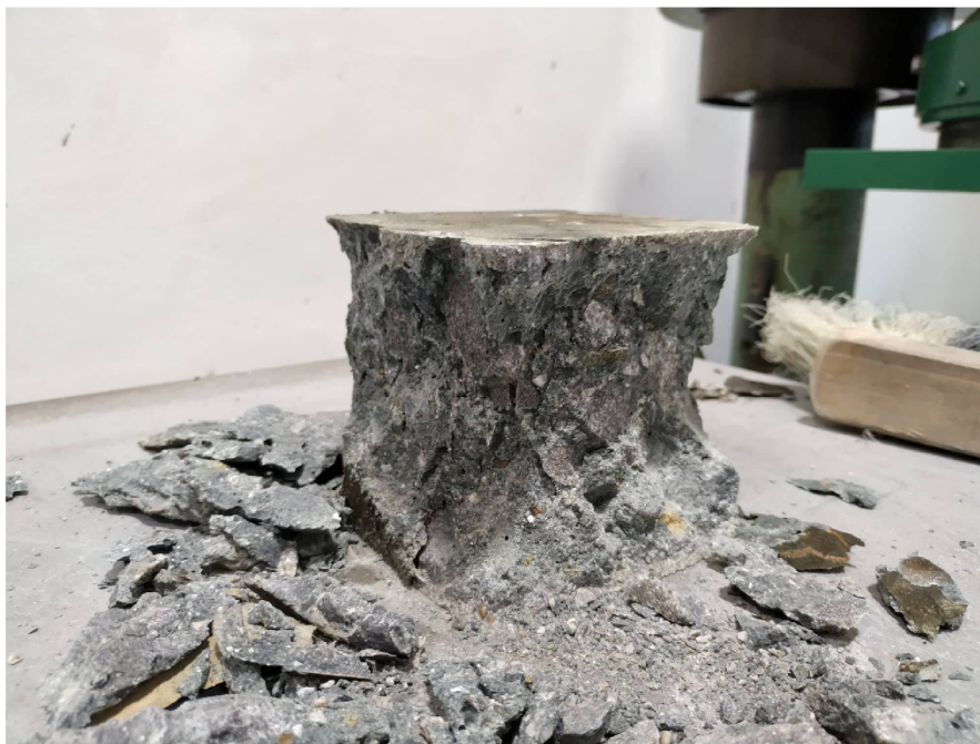
Obr. 11 správná deformace krychle po pomačkání na lisu
