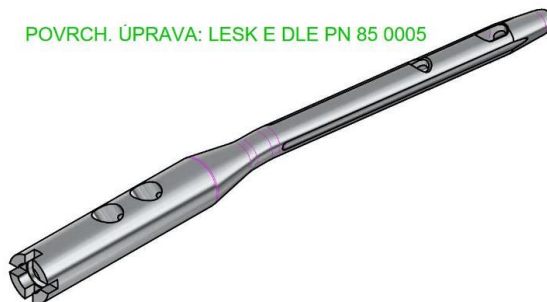
Obr. 6.3 Grafický náhled hřebu vyrobený z korozi-vzdorné oceli [5].
