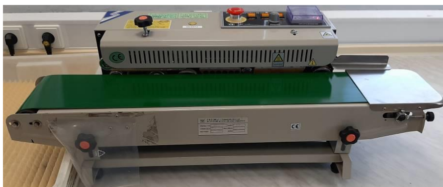
Obr. 7.24 Průběžná svářečka typu FR.
