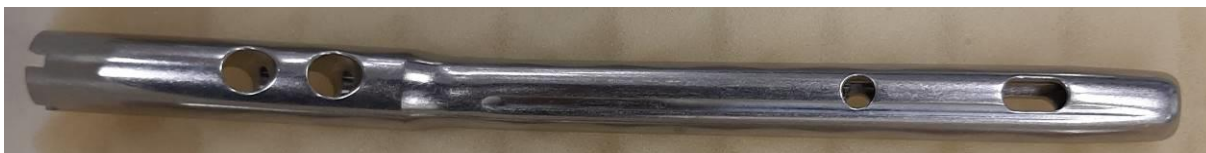
Obr. 7.16 Díl po operaci omílat a po mytí.
