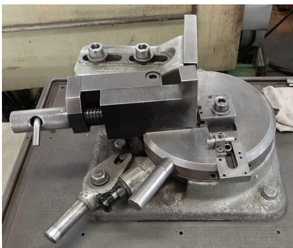
Obr. 7.8 Ruční ohýbačka SELZACH.
