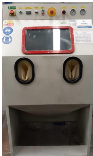
Obr. 7.26 Tryskací zařízení pro balotinování značky Wista.
