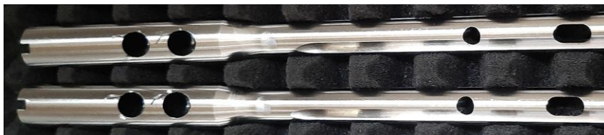
Obr. 7.11 Obrázek hřebů po obrábění.
