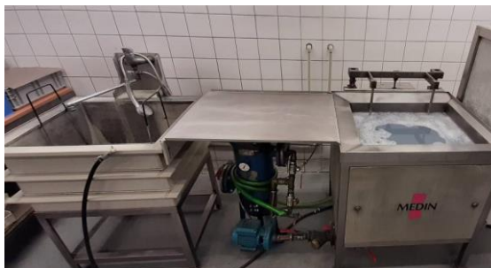
Obr. 7.6 Mezioperační mytí v odmašťovacím UZ zařízení.
