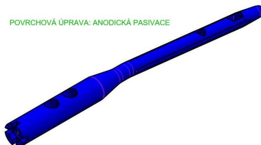
Obr. 6.4 Grafický náhled hřebu vyrobený z titanové slitiny [5].
