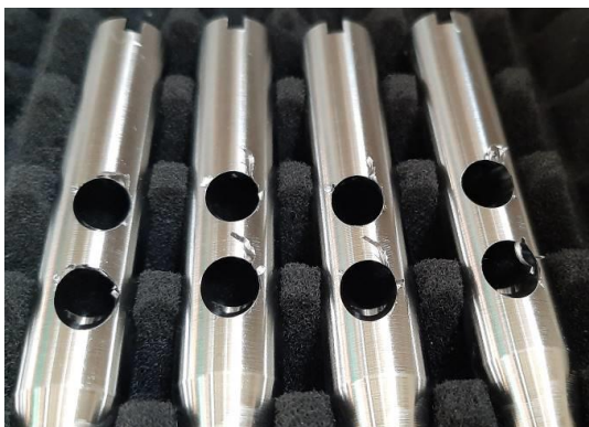
Obr. 7.12 Detailní zobrazení otřepů po obrábění.
