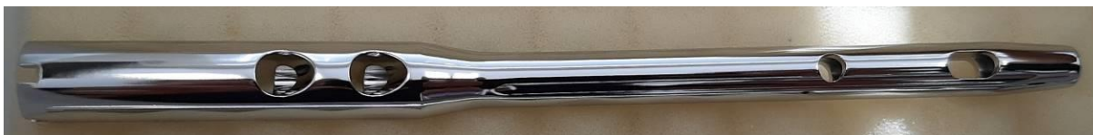
Obr. 7.17 Díl po elektrolytickém leštění.
