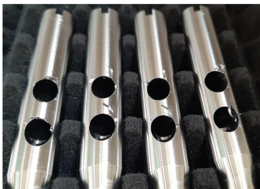
Obr. 7.12 Detailní zobrazení otřepů po obrábění.
