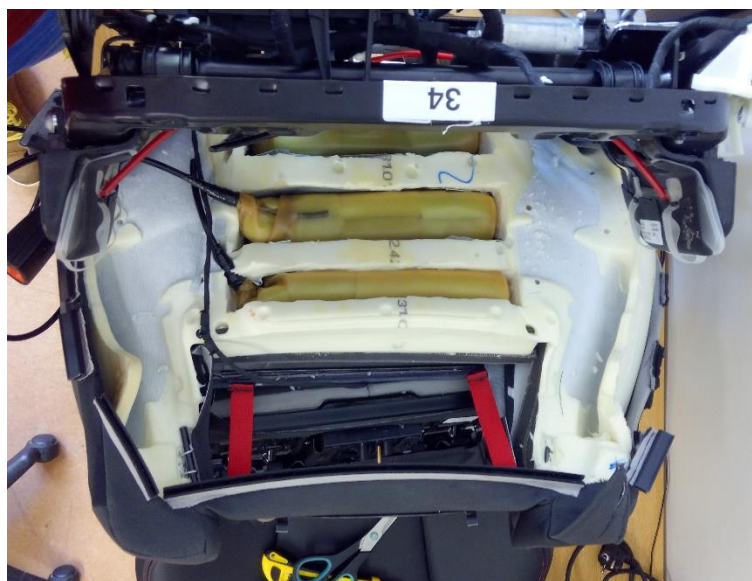
Obr. 24 Pryžové vaky umístěné v sedáku
