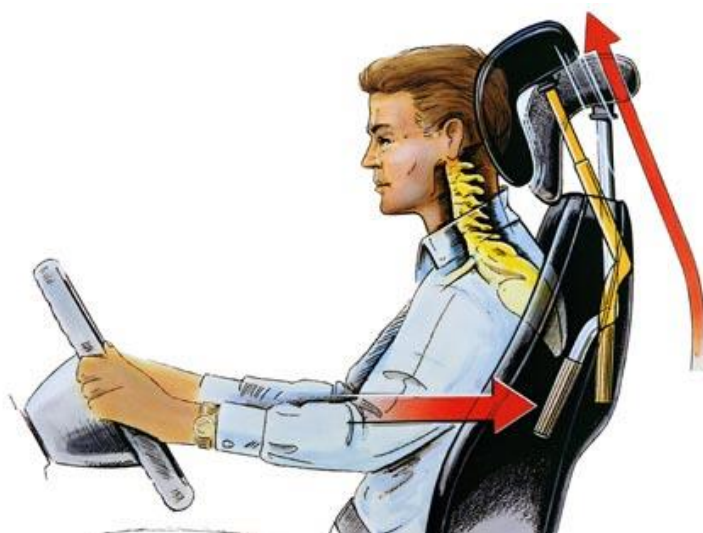
Obr. 4 Princip aktivní hlavové opěrky [5]
