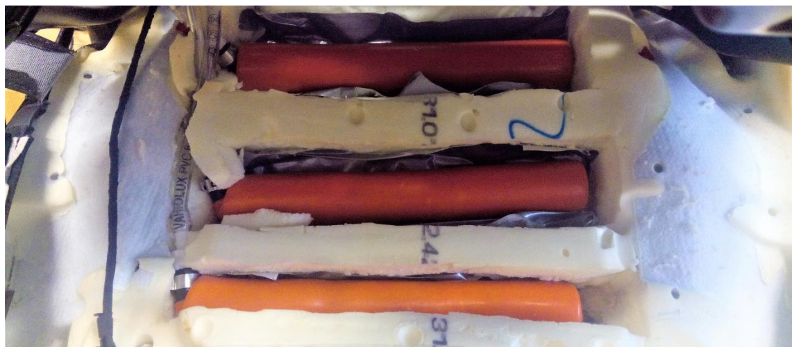
Obr. 33 Měchy vložené do kapes v korpusu sedáku (pohled na sedák ze spodní strany)
