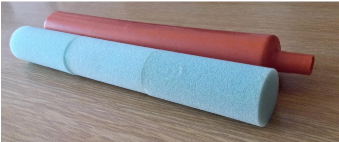
Obr. 31 Molitanové válečky před vsunutím do dutiny měchu
