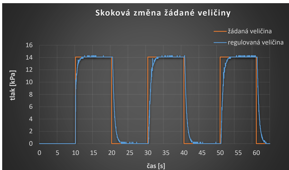
Obr. 56 Skoková změna žádané veličiny pro funkci ručního nastavení tuhosti
