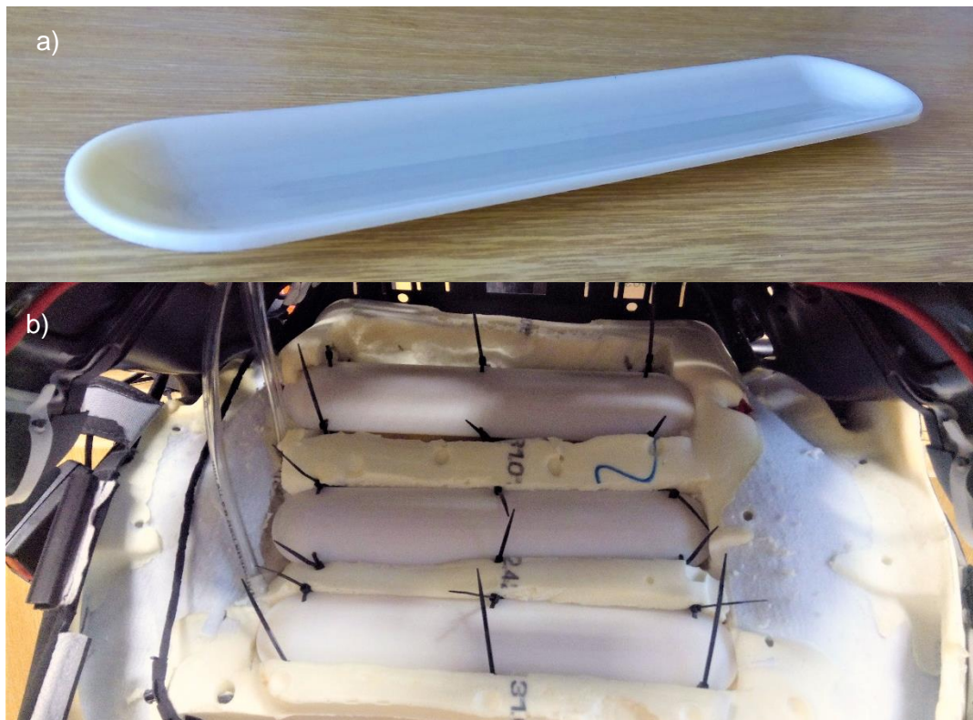
Obr. 38 a) Kryt vyrobený 3D tiskem – technologií Polyjet
