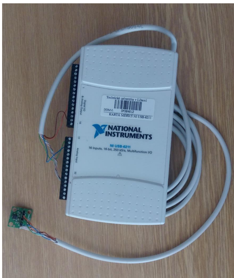
Obr. 46 Akcelerometr ADXL326 připojený na datovou kartu NATIONAL INSTRUMENTS NI USB-6211
