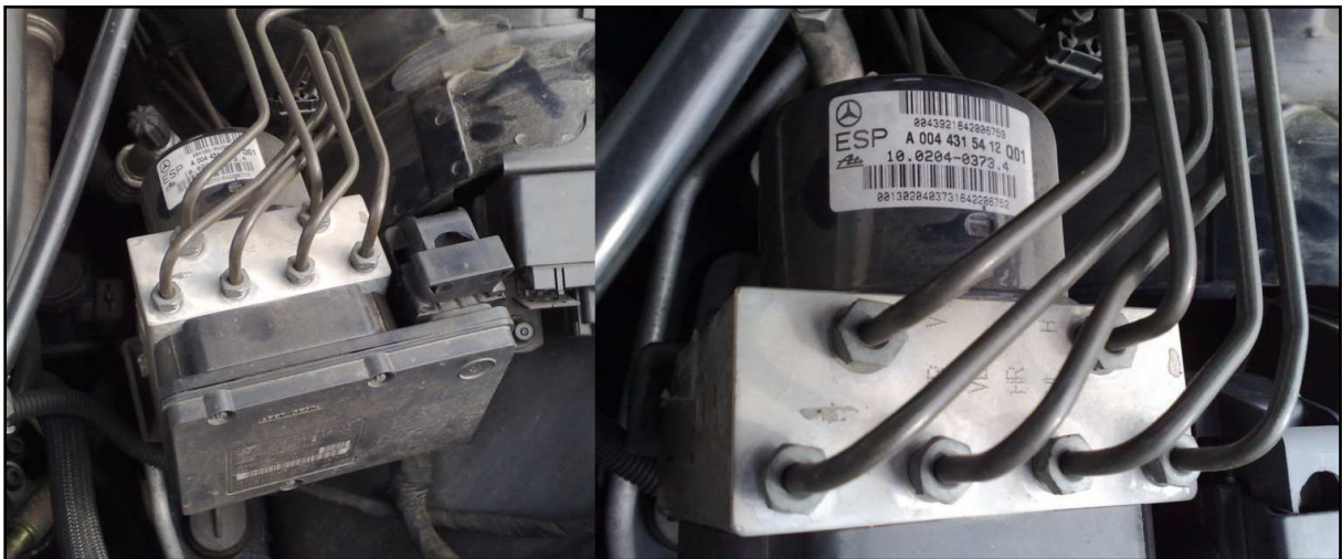
Obr. 7.2 Řídicí a hydraulická jednotka systému ABS a ESP ve vozidle [19]
