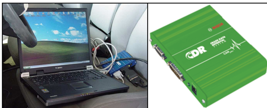
Obr. 5.2 Diagnostické zařízení BOSCH Crash Data Retrieval [8]
