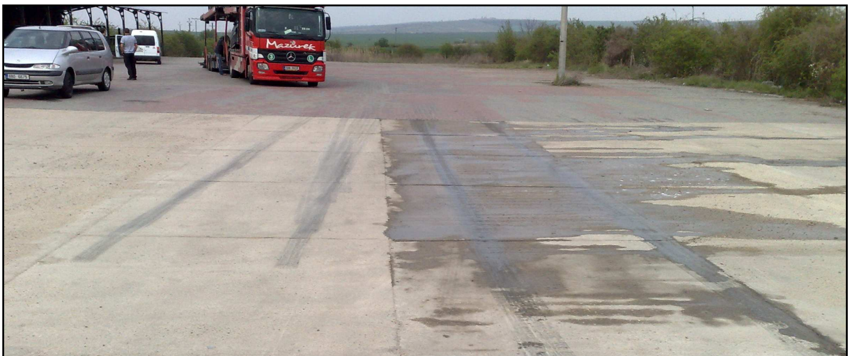
Obr. 7.5 Měřicí úsek po testech bez systému ABS [19]
