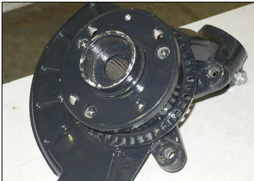
Obr. 3.16 Náboj kola s impulzním kolem [19]
