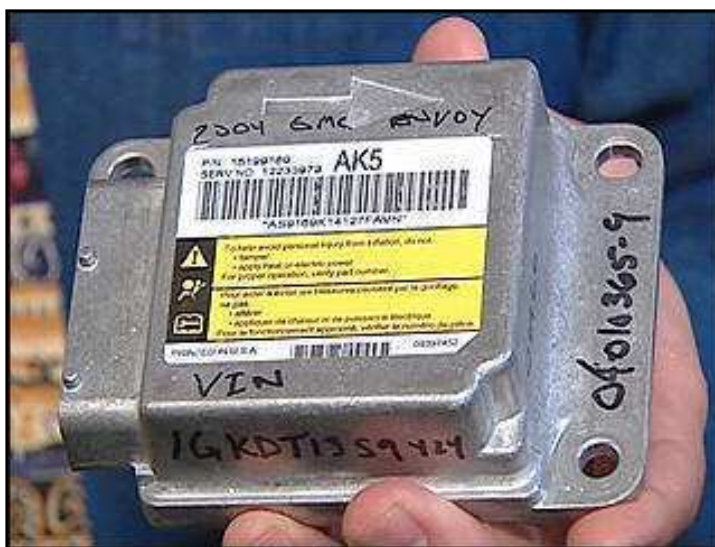
Obr. 5.1 Řídicí jednotka airbagu (ACM) obsahující EDR [17]
