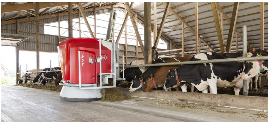
Obrázek 13: Krmný automat Lely Vector (Lely.com, 2021c)
