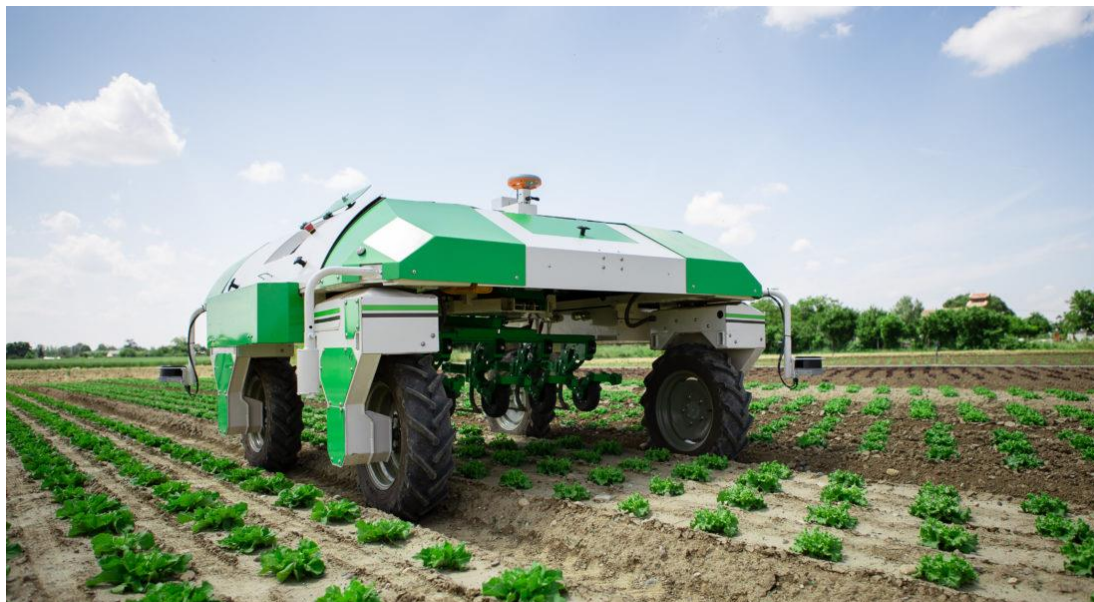
Obrázek 10: Odplevelovací robot Dino (Catinari, 2019)
