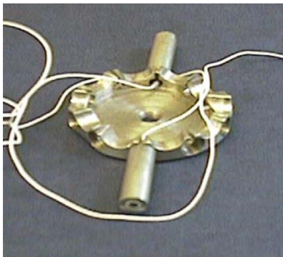
Obr. 8 Umístění dvou snímačů deformace v invarovém držáku [2]
