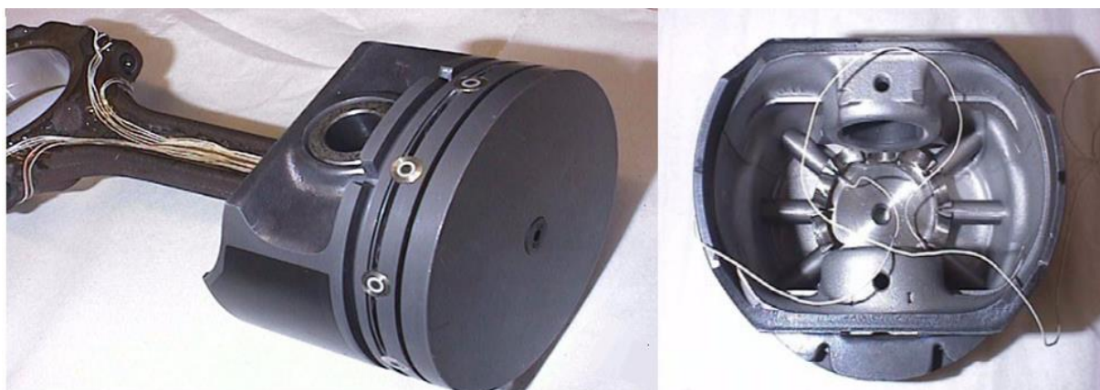
Obr. 9 Rovnoměrné rozmístění 10 snímačů ve dně pístu [2]
