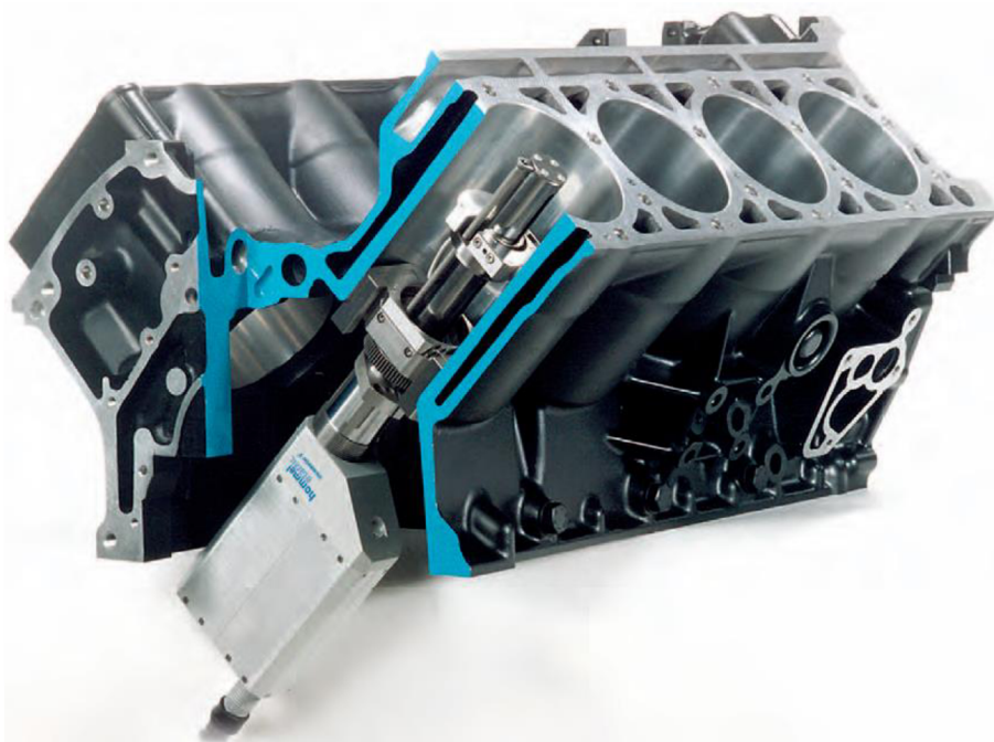
Obr. 5 Použití Incometeru při měření bloku osmi válcového motoru do V [7]
