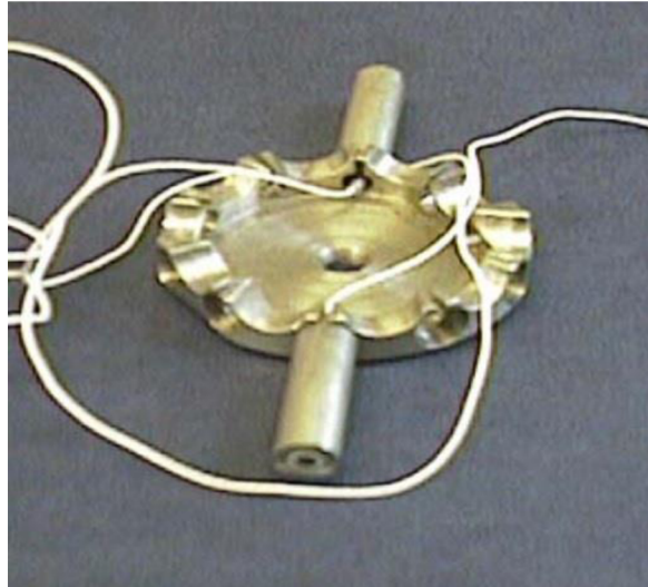
Obr. 8 Umístění dvou snímačů deformace v invarovém držáku [2]
