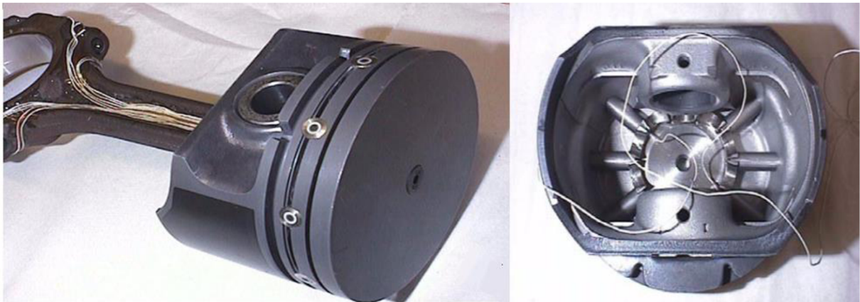
Obr. 9 Rovnoměrné rozmístění 10 snímačů ve dně pístu [2]
