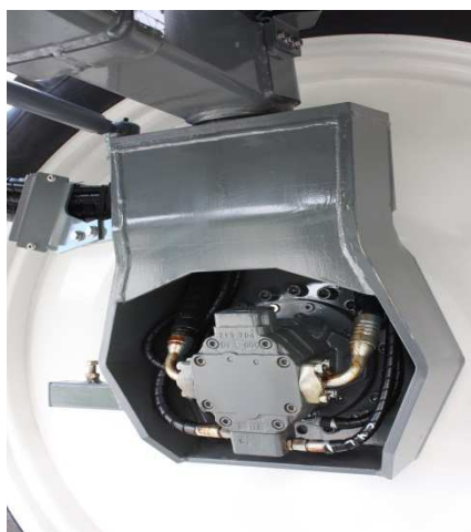
Obrázek 8 Pístový hydromotor v náboji kola
