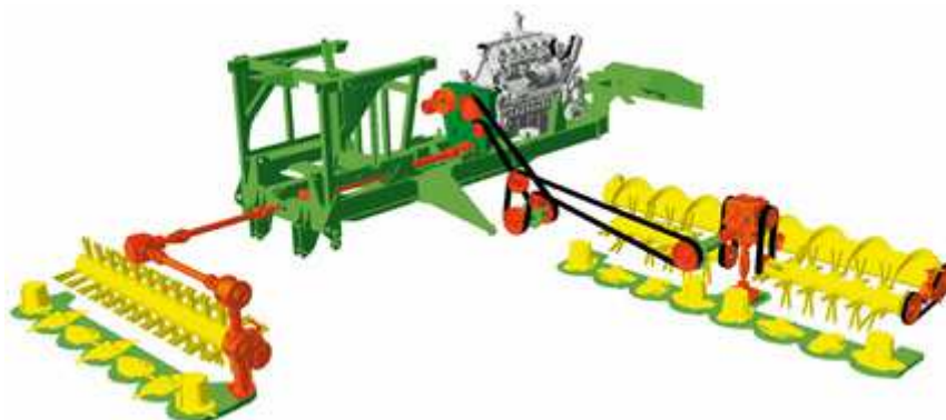
Obrázek 14 Pohon žacích diskových ústrojí stroje KRONE BIG M
