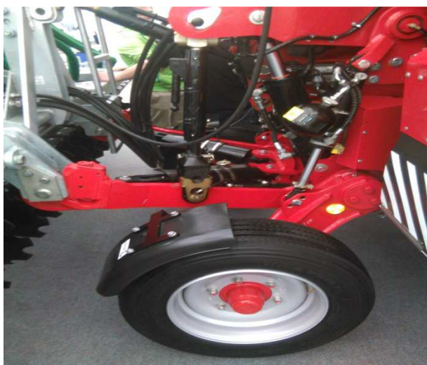
Obrázek 40 Provedení zadního 3bodového závěsu Holmer Terra Variant
