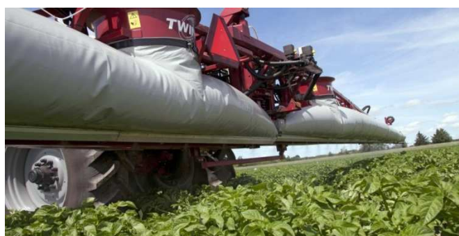
Obrázek 12 Ukázka systému TwinForce u postřikovače značky Hardi
