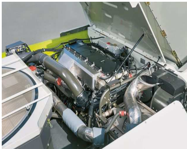
Obrázek 4 Ukázka motoru uložený příčně,
