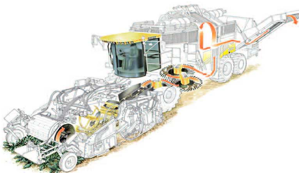
Obrázek 35 Základní schéma toku materiálu sklízěčem cukrové řepy
