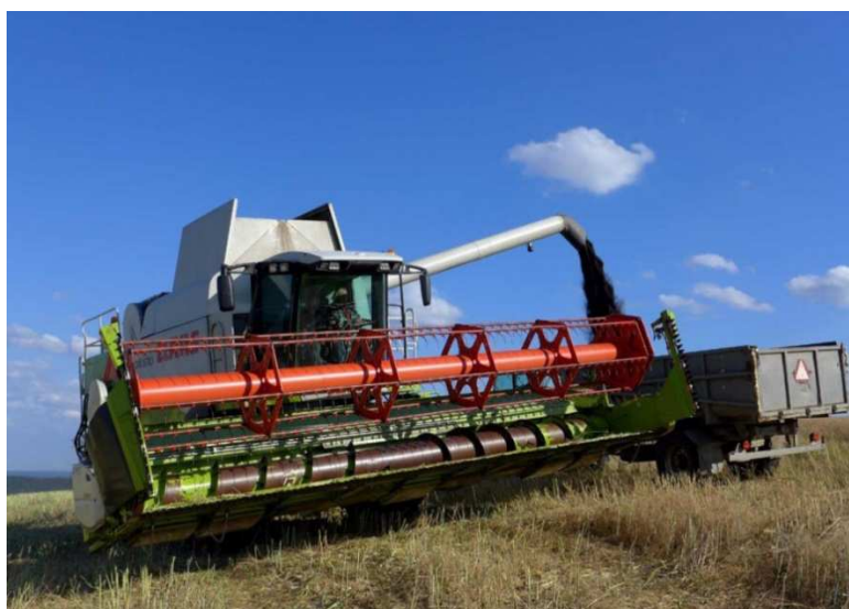
Obrázek 29 Obilný adaptér Claas V750 upravený na sklizeň řepky olejky
