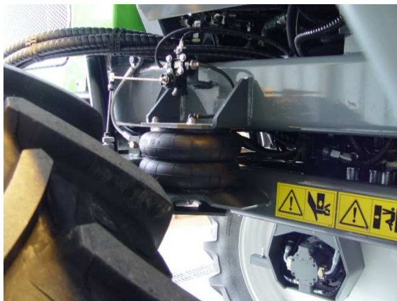
Obrázek 9 Odpružení samojízdného postřikovače
