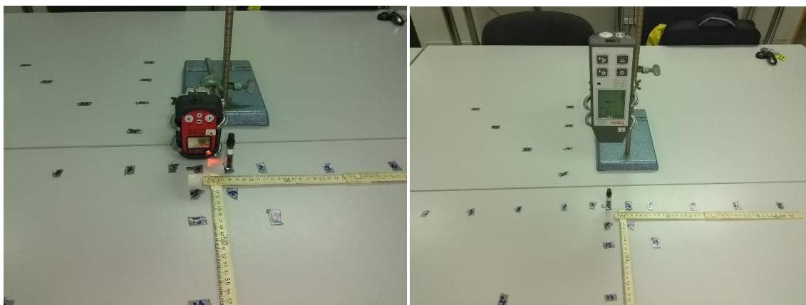
Obrázek 15 Měření bodového zářiče pomocí přístroje RadEye G-10 a přístroje Thermo FH 40 G v různých výškách, Zdroj: (vlastní)
