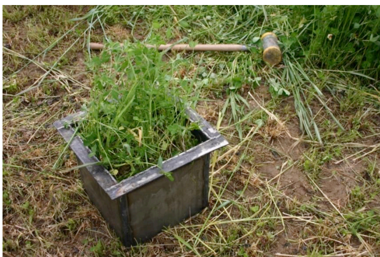
Obr. 18: Metoda monolitu - rám s odebraným půdním monolitem.
