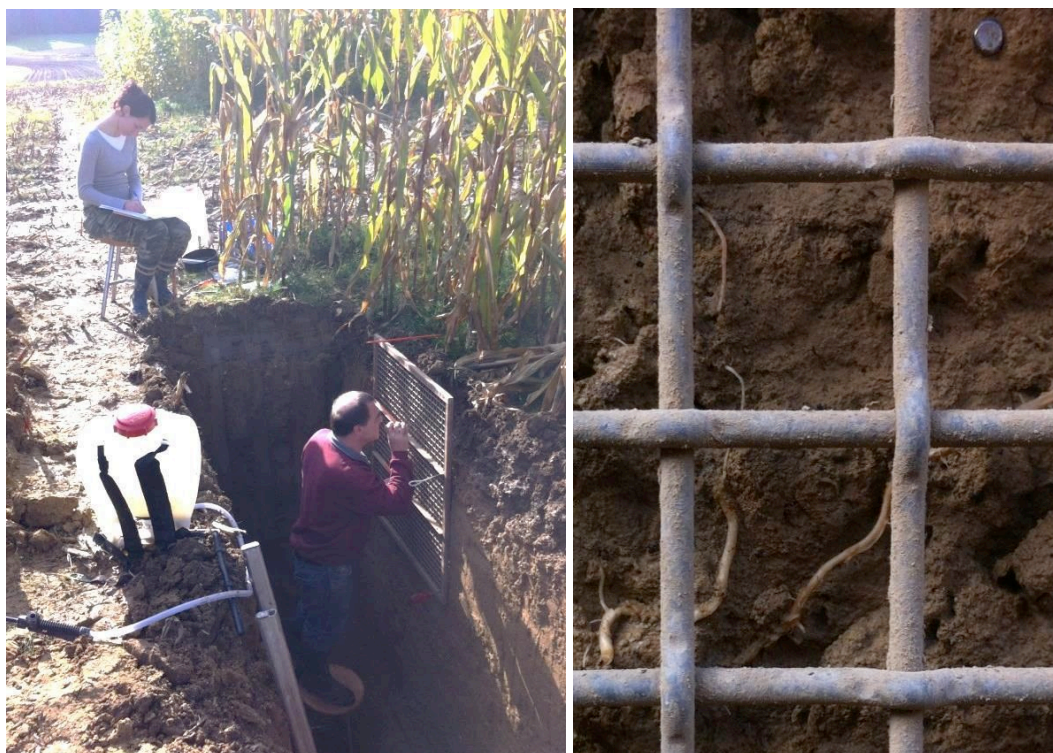
Obr. 24: Metoda profilové stěny - průběh metody profilové stěny a detail hodnocených kořenových dělek.
