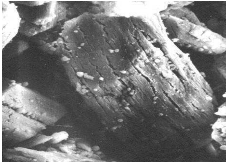
Obr 3: \beta -sádra ve formě silně rozlískované pseudomorfózy po sádrovci (zvětšení 4000x)
