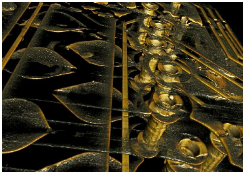
Obr. 3.8: 3D pohled znázorňující prokovy u 4 vrstvé DPS.
