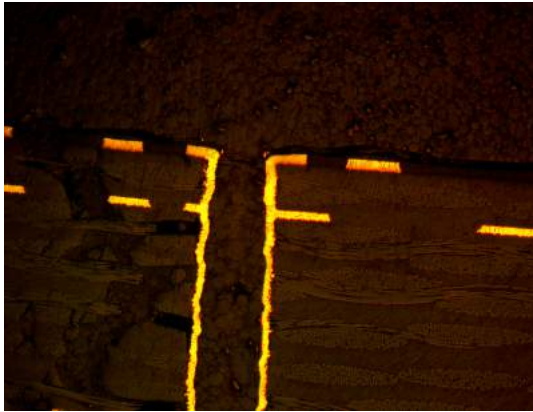
Obr. 3.17: Mikrovýbrus DPS pro automotive I. - bez defektu.
