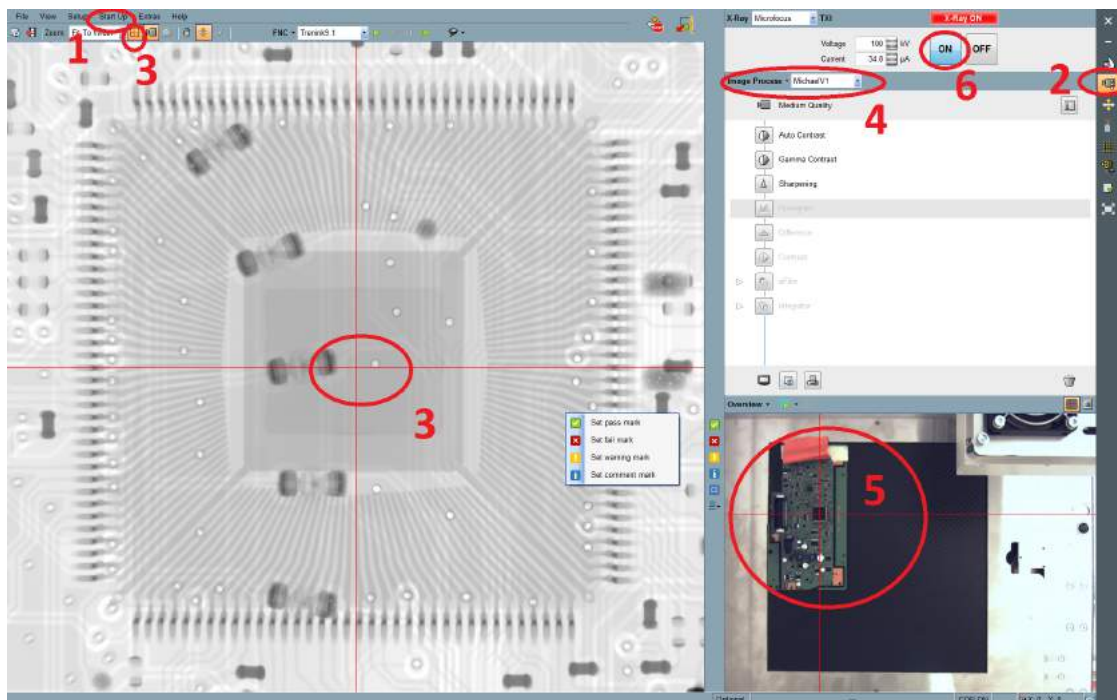
Obr. 2.6: Počáteční nastavení - 1. Start up - Start all/reference drive, 2. Image processing workspace, 3. Cross-hair, 4. Image process, 5. Display overview image, 6. RTG ON
