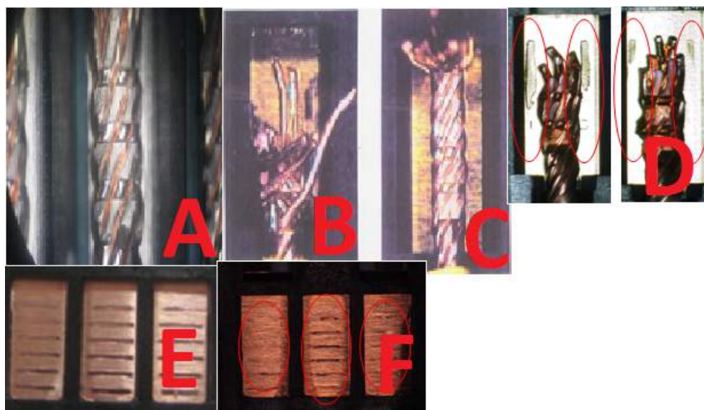
Obr. 3.31: Ukazatele jakosti - optická detekce: A) OK žádoucí stav - minimálně 2 pruhy po svařování, B) NG roztřepené vodiče, C) NG vodiče mimo blok, d) NG viditelný středový vodič blok, E) OK minimálně 6 viditelných vrypů na spodní straně, F) NG absence vrypů.
