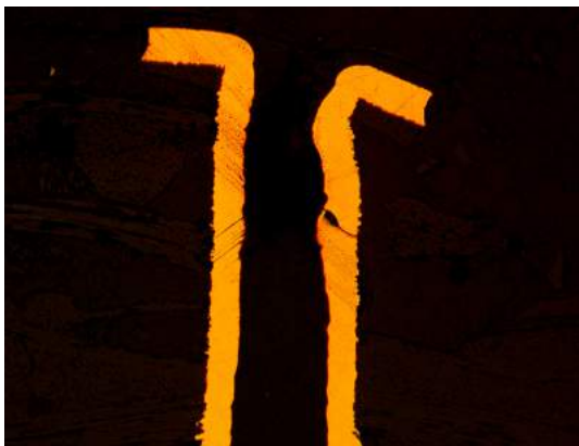
Obr. 3.22: B prasklina detail I.
