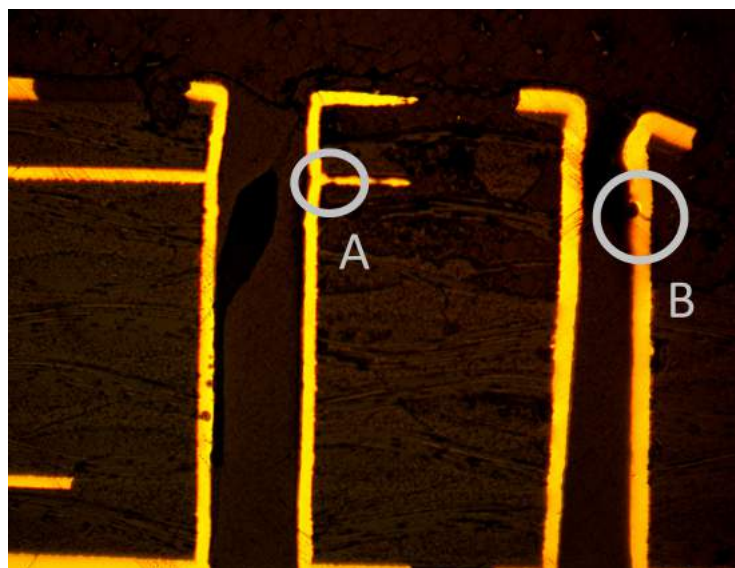
Obr. 3.19: Mikrovýbrus DPS pro spotřební elektroniku - Nalezeny 2 praskliny A, B
