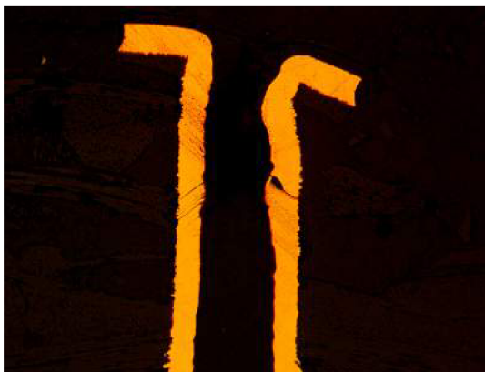
Obr. 3.22: B prasklina detail I.
