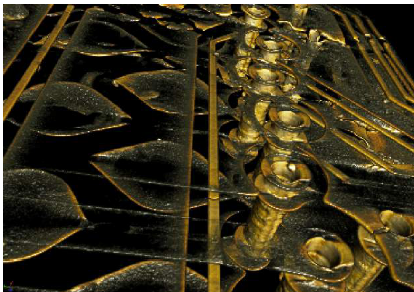
Obr. 3.8: 3D pohled znázorňující prokovy u 4 vrstvé DPS.
