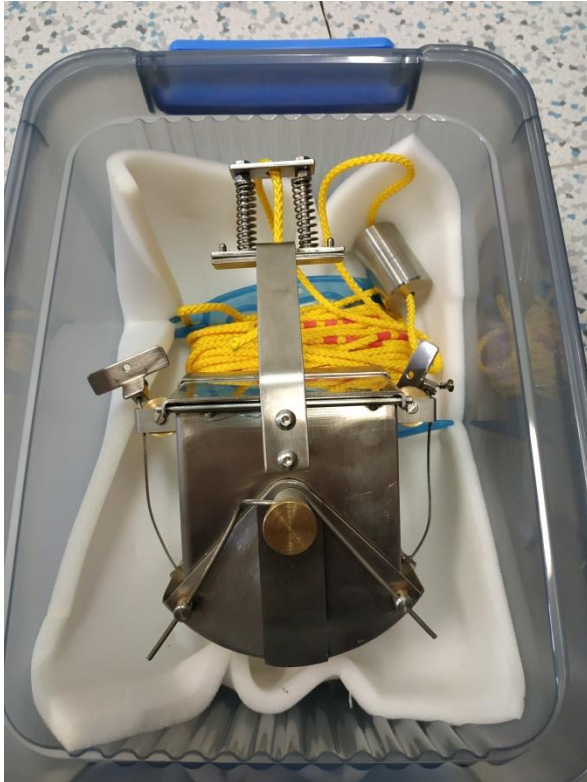
Obr. 6: Ekmanův drapák s odběrovou plochou 1 dm 2 .
