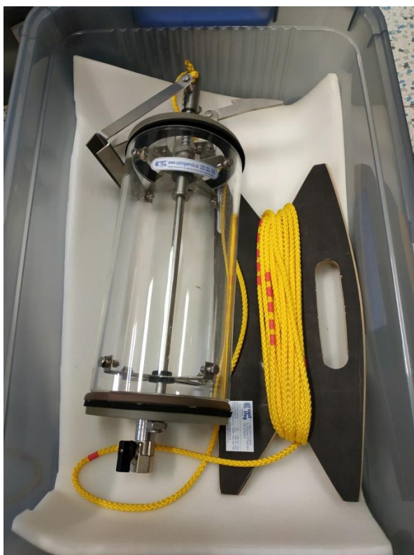
Obr. 5: Odběrák typu Van Dorn s odběrovým množstvím 3 litry.
