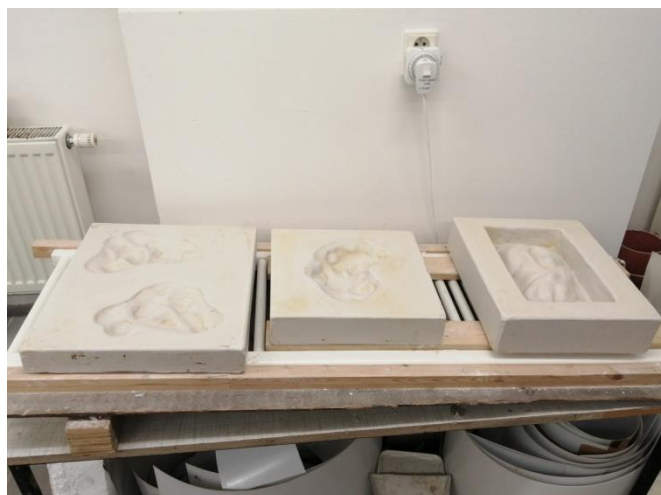
Obr. 5.3 Schnoucí sádrové formy
