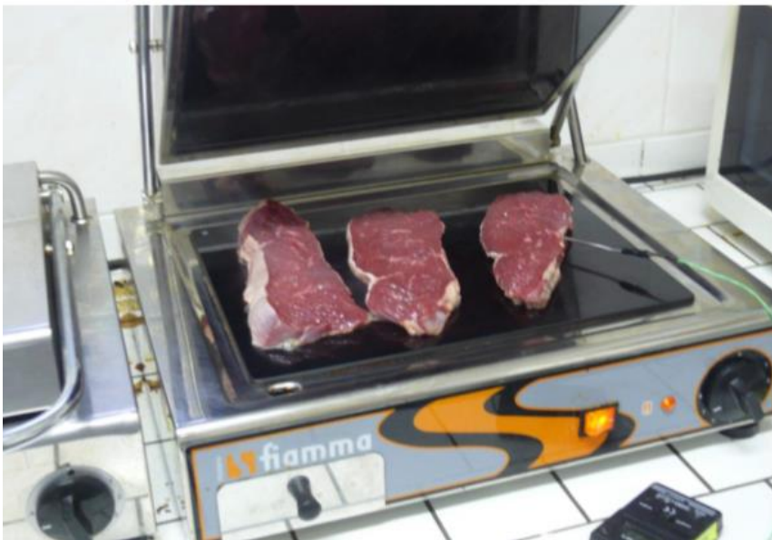
Obrázek č.5 – Grilování masa na oboustranném kontaktním grilu s přiloženým digitálním kontaktním teploměrem
