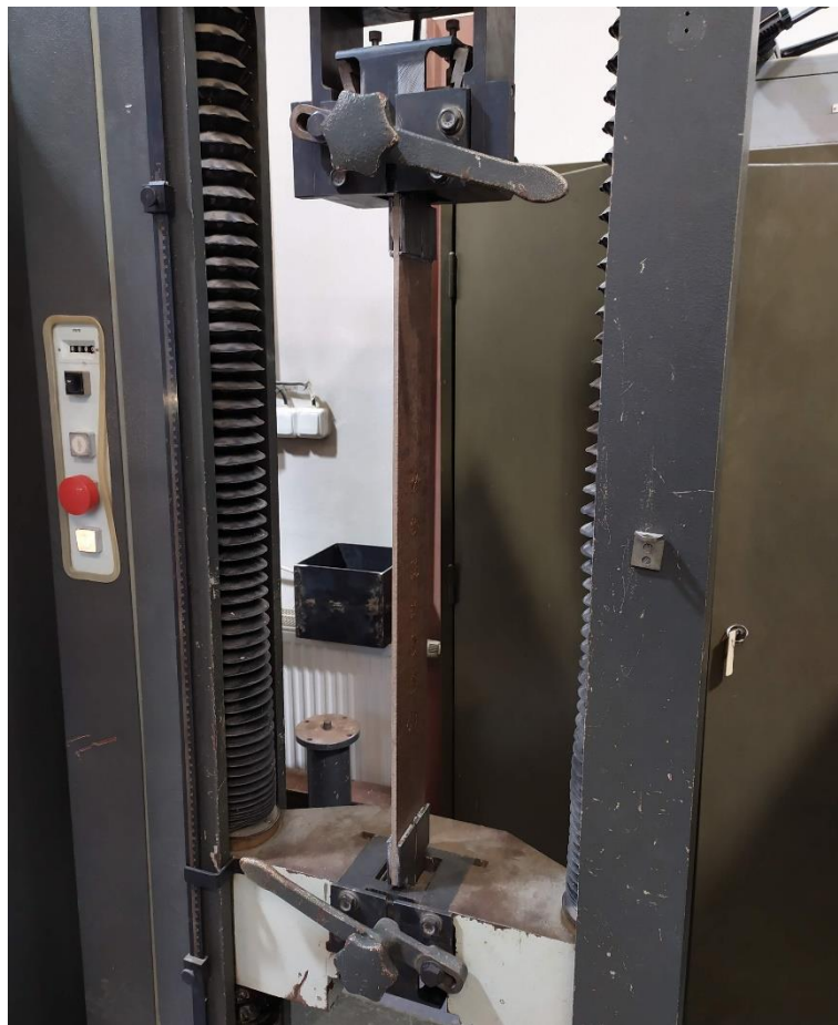
Obr. P10 Osazení zkušebního tělesa do lisu.
