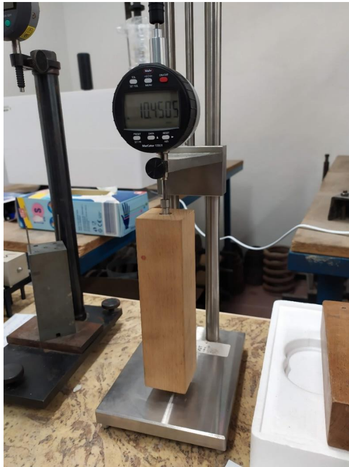
Obr. 34 Zkušební zařízení pro měření smrštění, měření kalibračního etalonu.
