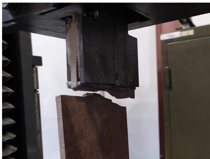
Obr. P12 Detail porušení zkušebního tělesa při zkoušce rychlosti šíření ultrazvuku při zatížení.
