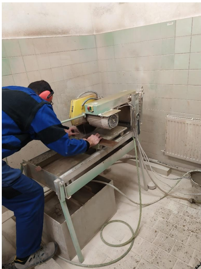
Obr. P6 Řezání těles pro doplňující zkoušky velkoformátových obkladů.
