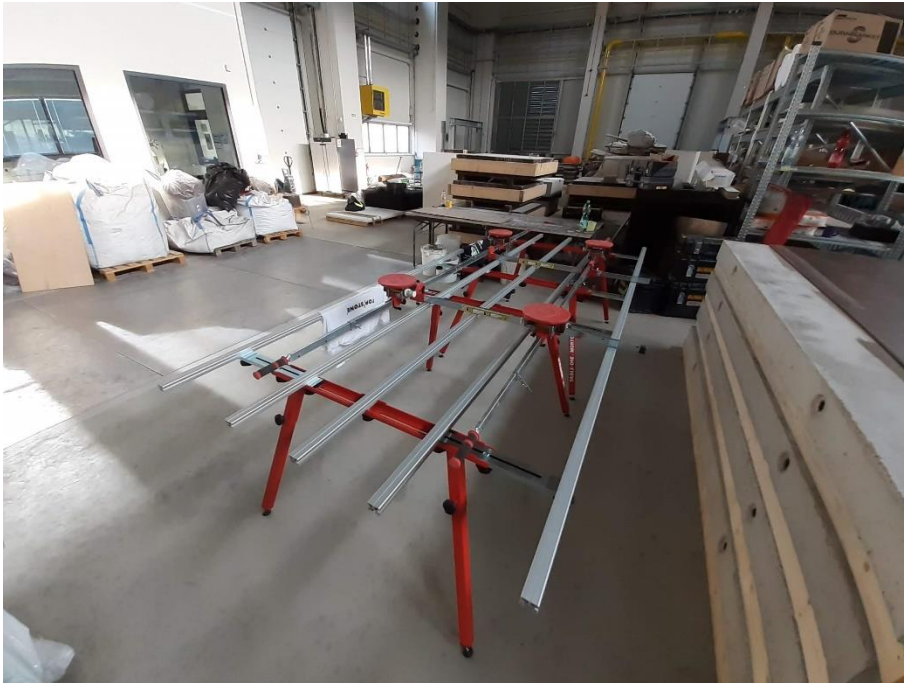
Obr. P1 Manipulační rám pro práci s velkoformátovými obklady.
