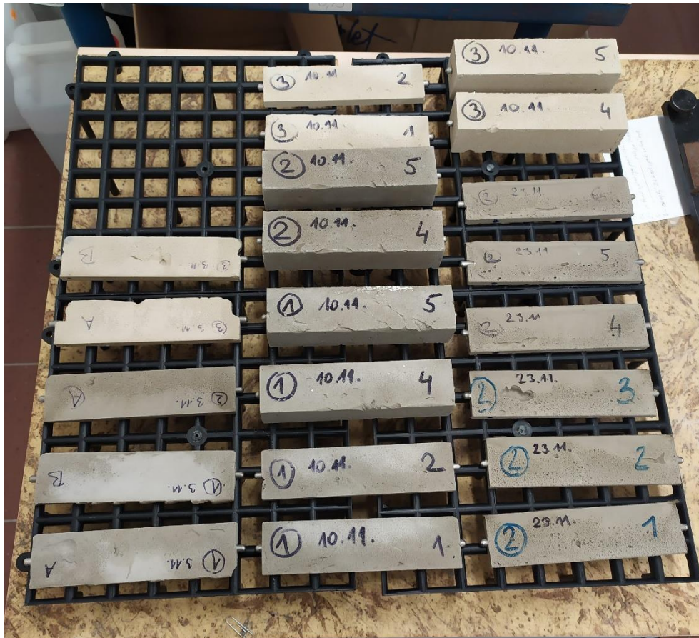
Obr. 26 Zkušební tělesa pro měření smrštění lepidel.
