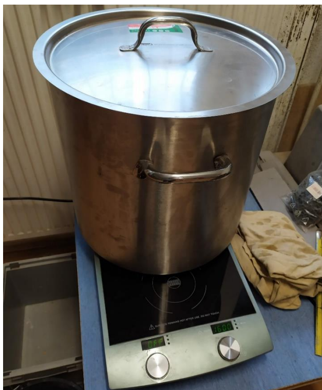
Obr. 21 Zkouška nasákavosti varem.
