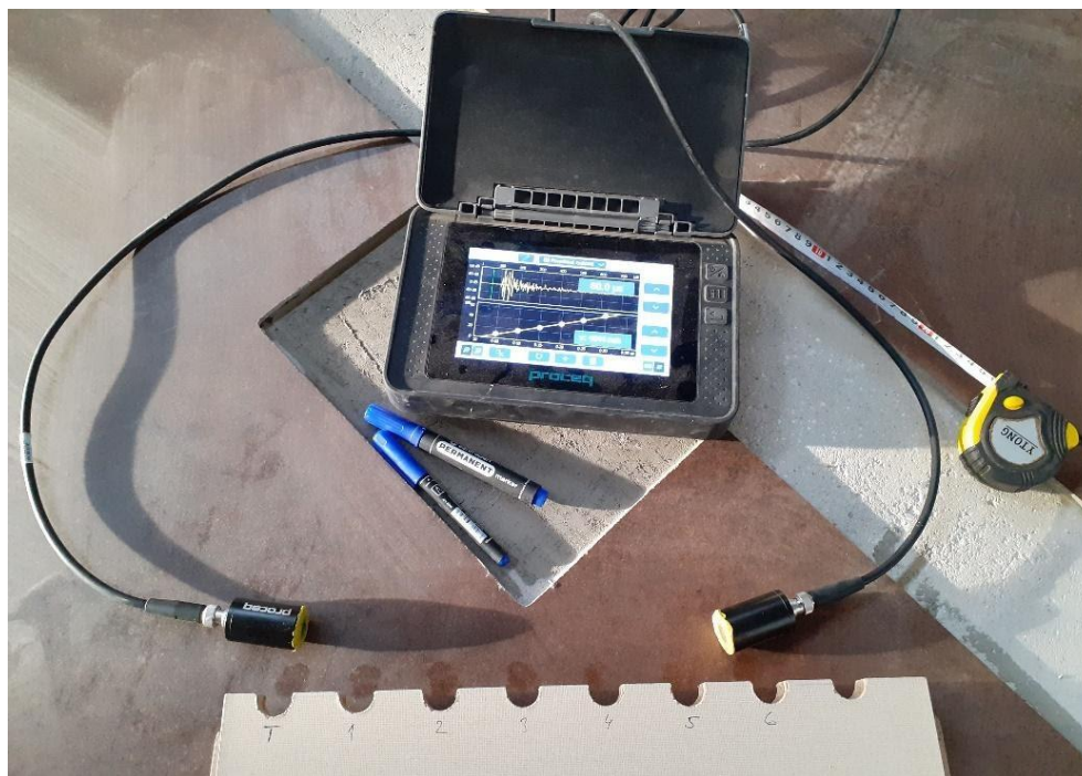
Obr. 16 Ultrazvukové měření v rámci první etapy.
