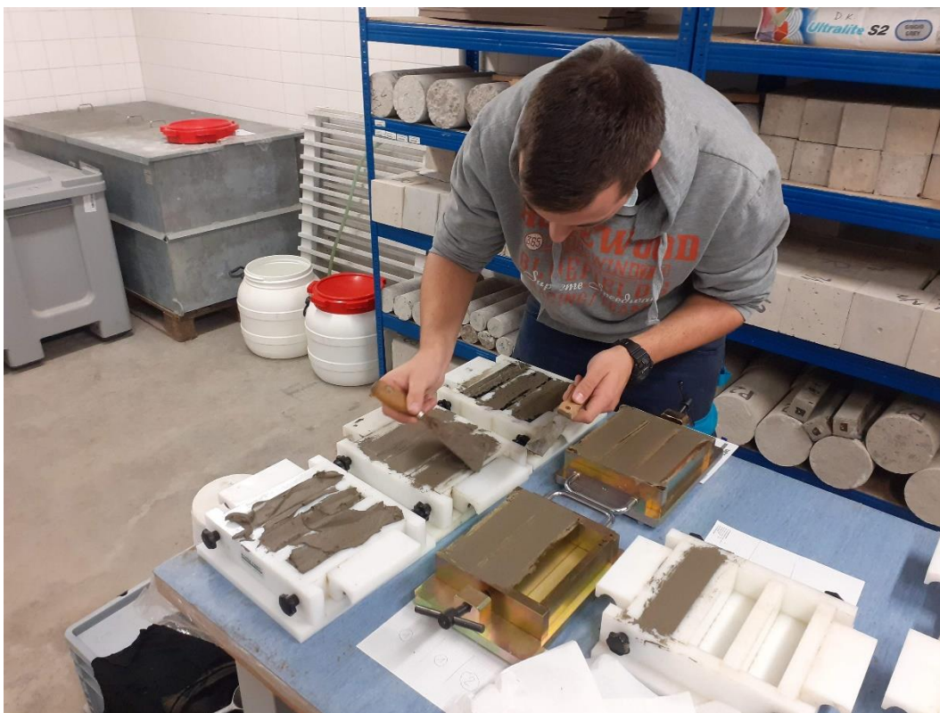
Obr. P17 Výroba zkušebních těles z lepidel – plnění forem.
