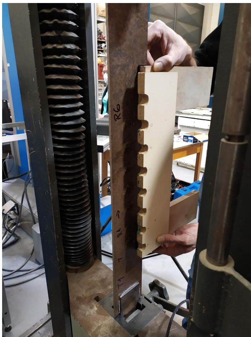
Obr. 22 Zkouška rychlosti šíření UZ vlnění při zatížení.
