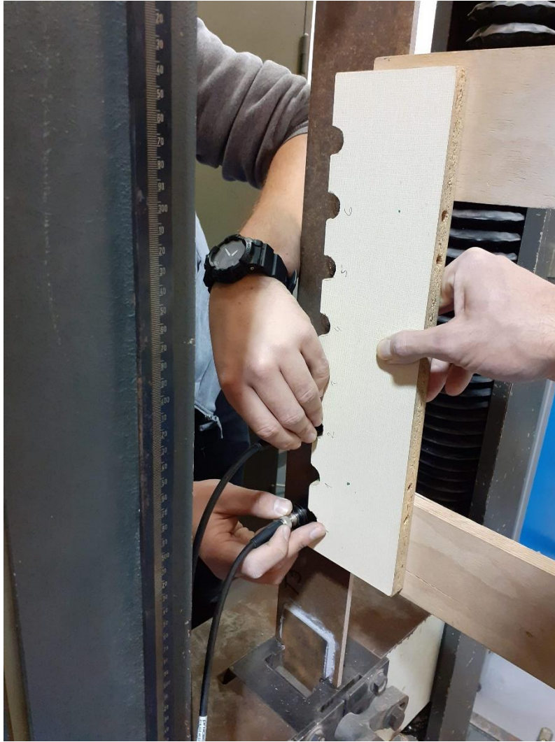
Obr. P11 Měření rychlosti šíření ultrazvuku při zatížení.
