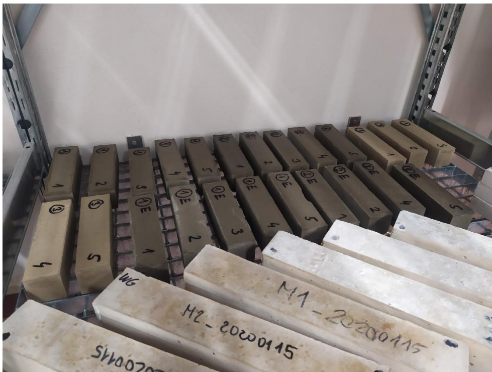
Obr. 27 Zkušební tělesa pro zkoušky pevností a modulů pružnosti.
