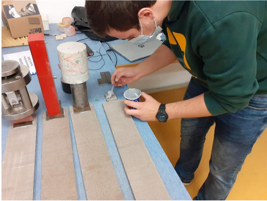
Obr. P9 Příprava zkušebních těles pro zkoušku rychlosti šíření ultrazvuku při zatížení.
