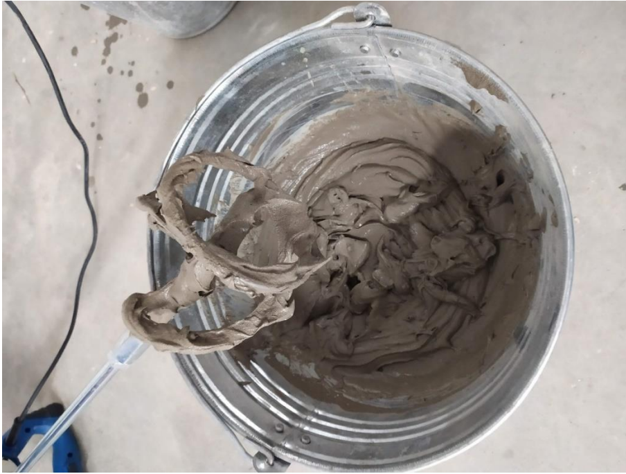
Obr. 23 Výroba první sady zkušebních těles – lepidlo 2 (3. 11. 2020).
