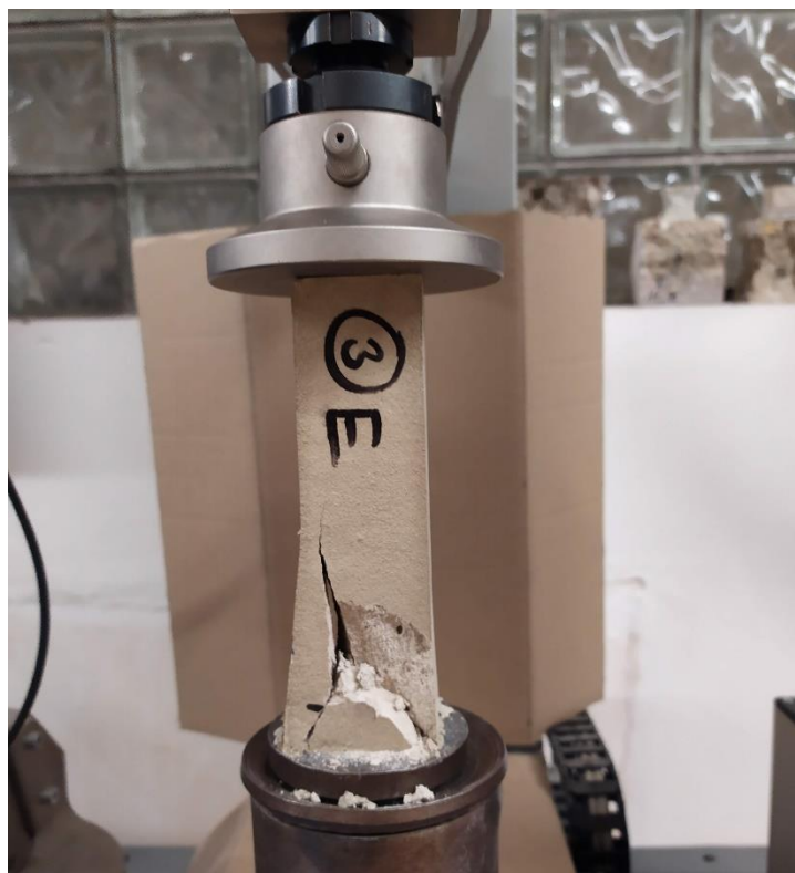
Obr. P23 Zkouška pevnosti zkušebního tělesa v tlaku po ukončení zkoušky statického modulu pružnosti.
