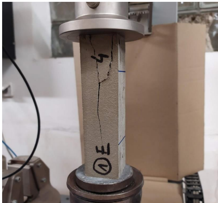
Obr. 31 Zkouška pevnosti v tlaku, která následovala po zkoušení modulu pružnosti.
