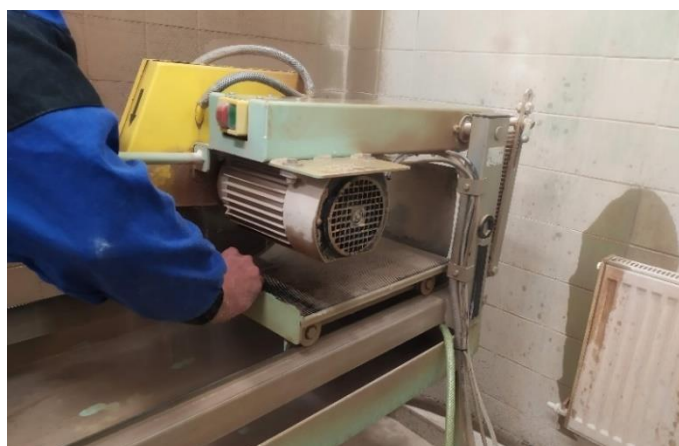
Obr. 10 Řezání zkušebních těles pro doplňkové zkoušky velkoformátových obkladů.
