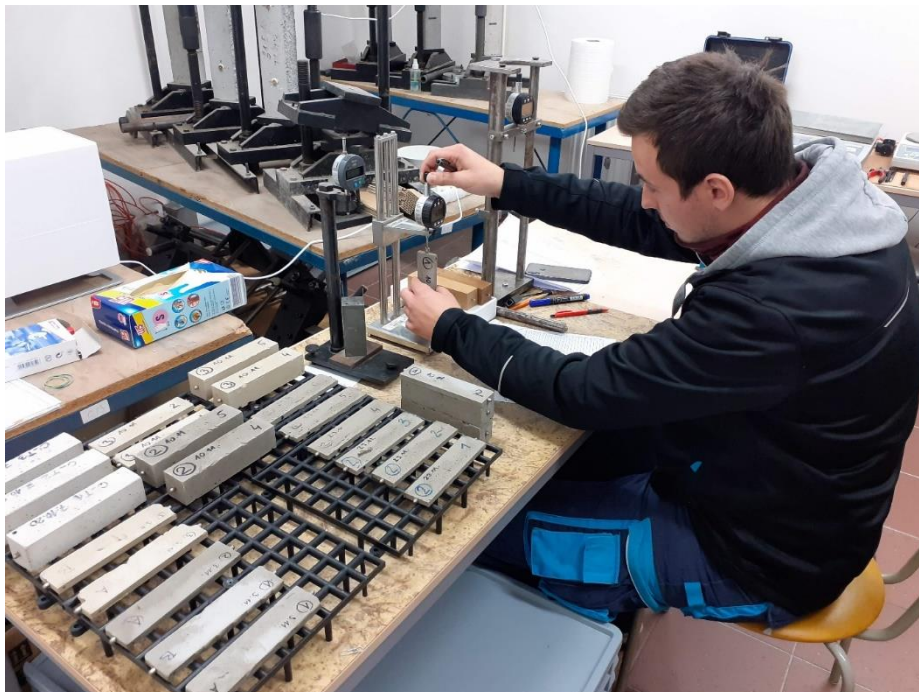
Obr. 35 Měření smrštění na zkušebním tělese z cementového lepidla.
