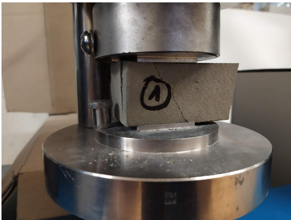
Obr. 33 Zkušební těleso z lepidla 1 po zkoušce pevnosti v tlaku.
