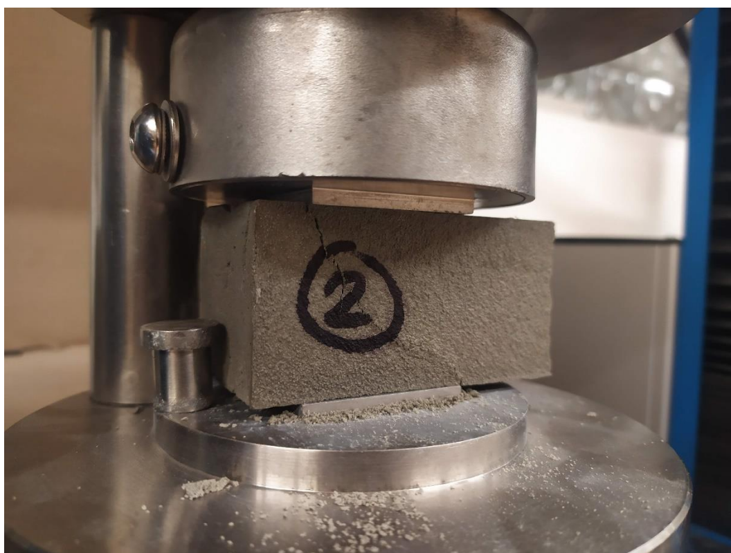
Obr. P20 Zkoušení pevnosti lepidel v tlaku – lepidlo 2.
