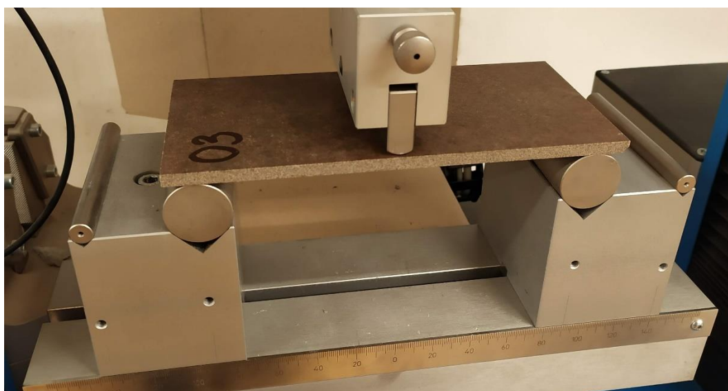
Obr. P8 Zkouška pevnosti v ohybu obkladového prvku.
