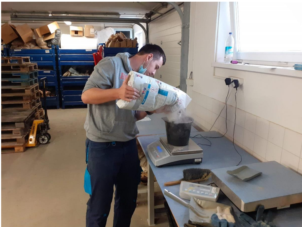
Obr. P16 Výroba zkušebních těles z lepidel – odvažování suché směsi.
