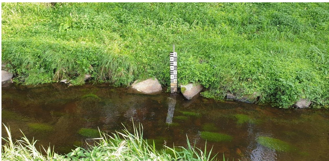
Obr. 5.18 – Vodočetná lať výšky 1 m
