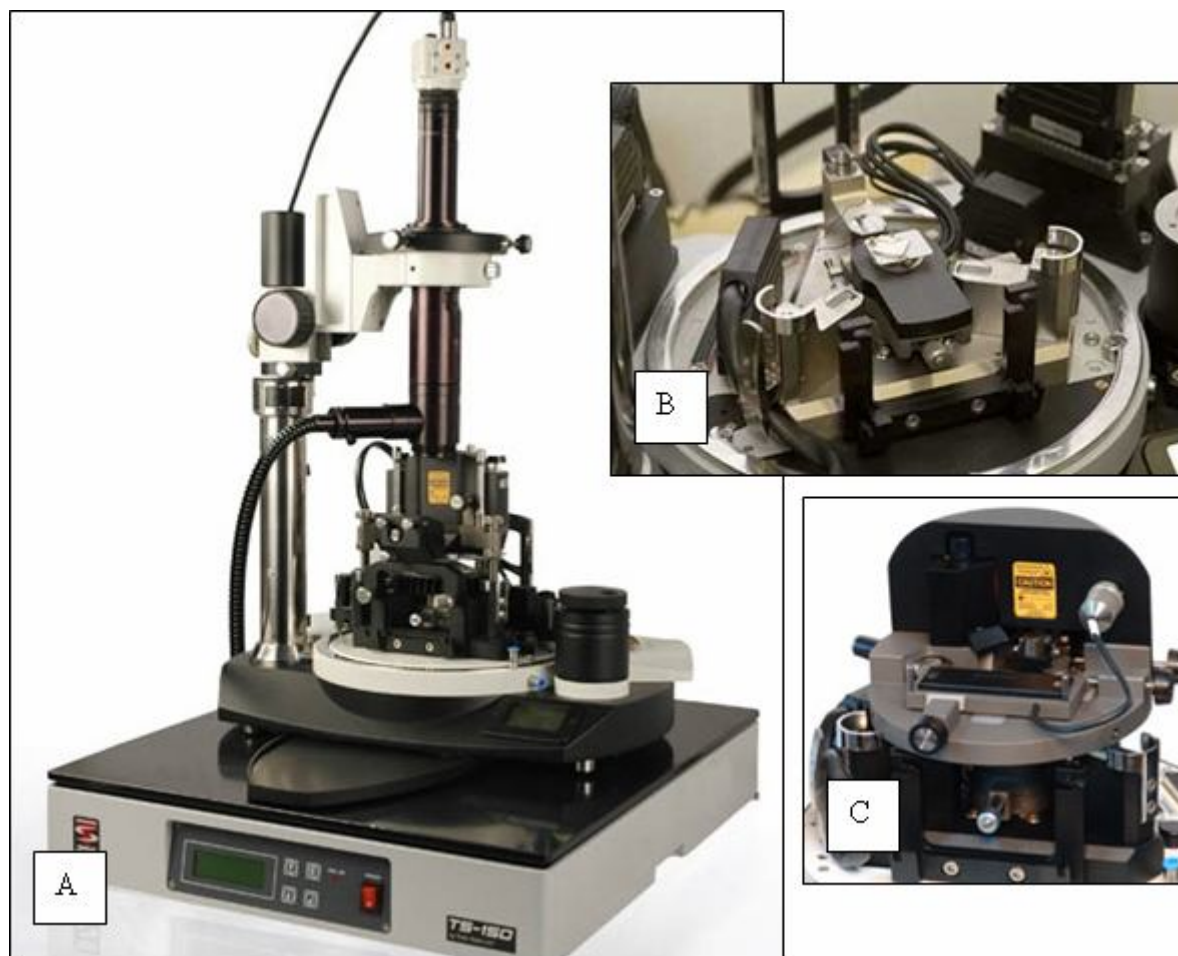
Obr. 29: A – kompletne zariadenie AFM platformy NTEGRA Prima [27], B – detail na miesto umiestnenia vzorky (v strede) [28], C – detail na základnú skenovaciu hlavu [27]
