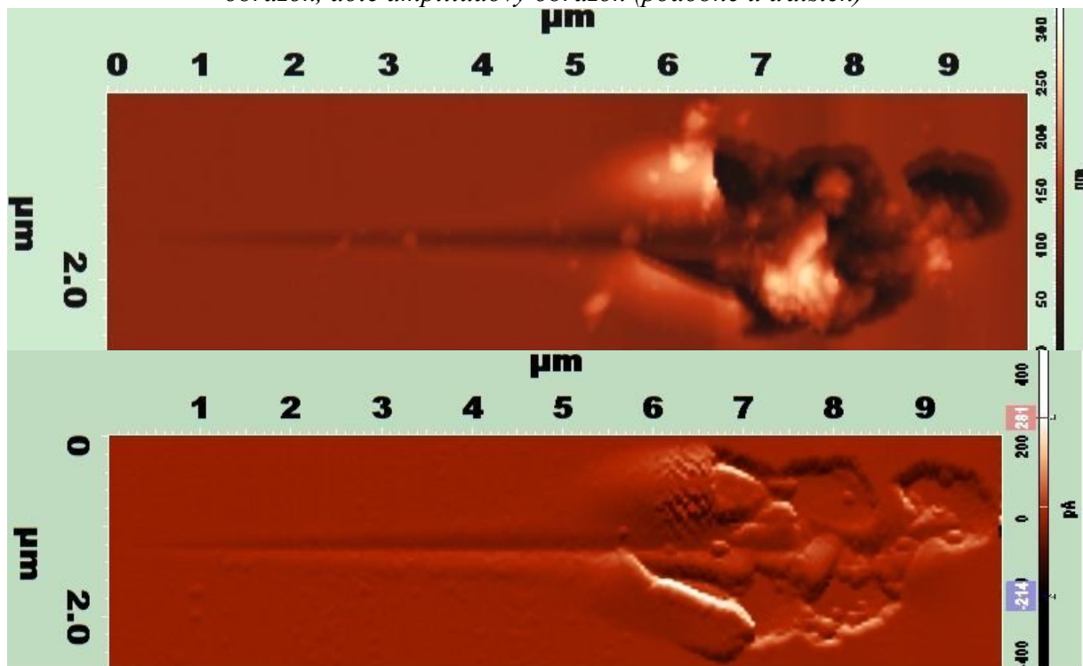
Obr. 43: Ukážka vrypu vo vzorke (A 3101 a) s modulom pružnosti 33 GPa
