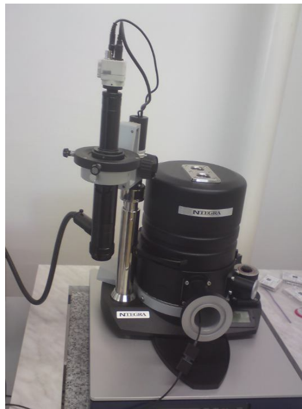
Obr. 35: Pohľad na prístroj NTEGRA počas vykonávania vrypovej skúšky (kryt je kvôli odizolovaniu od možných zdrojov okolných vibrácií)
