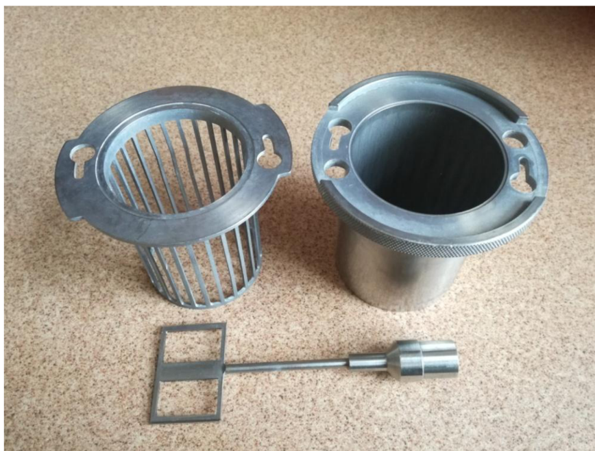
Obrázek 33 Zkušební geometrie BCM, tzv. celo pro stavební materiály
