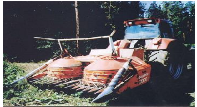
Obr. 13.: Řezačka Kemper v úpravě na konopí [6]
