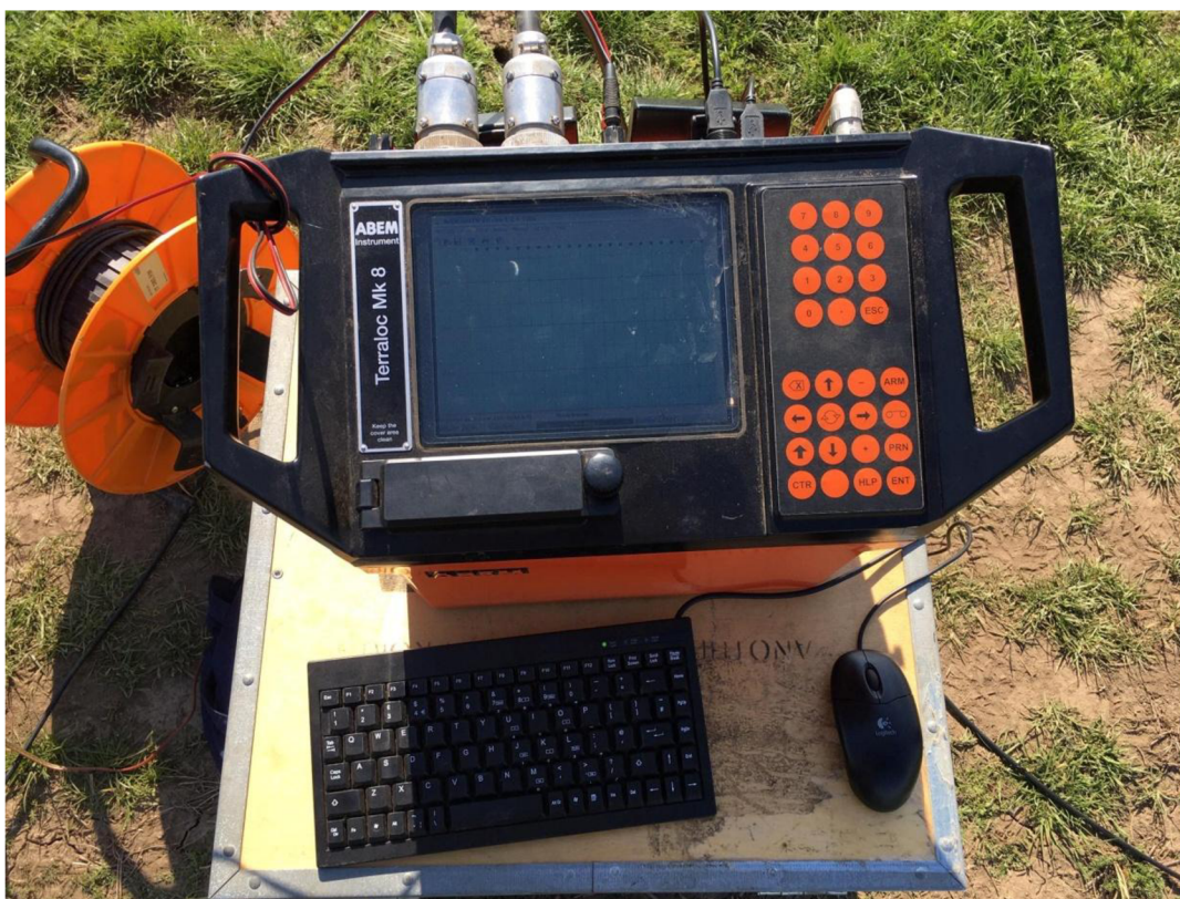
Obr. 23: Seismograf Terralock Mk-8 od švédské firmy ABEM (autor fotografie: Lukáš Maloušek).
