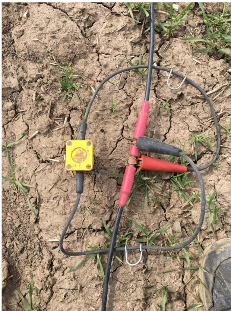
Obr. 24: Geofon typu SM-48 připojený k seismickým kabelům (autor fotografie: Lukáš Maloušek).
