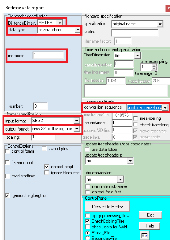
Obr. 26: Nastavení parametrů při importu dat v programu ReflexW.
