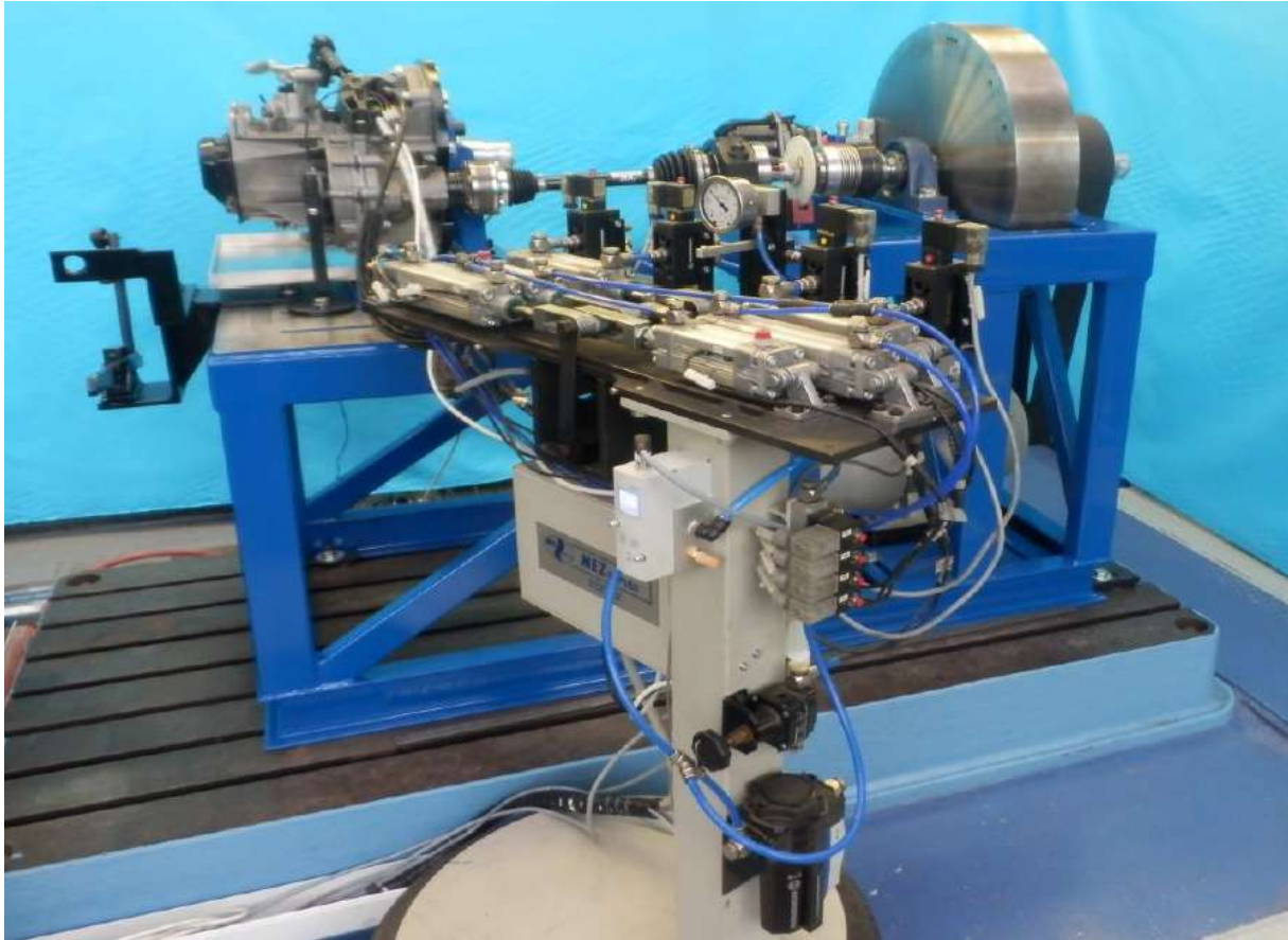
Obr. 21 Pneumatické řazení a použitý setrvačnick [10]
