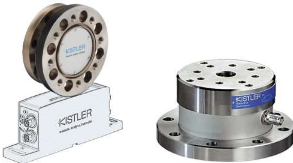
Obr. 17 Příklady snímačů momentu od firmy Kistler [5] (na levé straně tenzometrická příruba pro měření točivého momentu a na pravé straně piezoelektrická příruba pro měření kroucího momentu)
