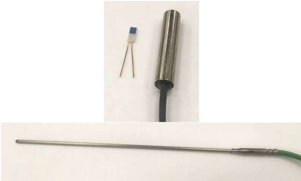
Obr. 11 Příklad elektrických snímačů teploty (na horním obrázku odporový snímač Pt100, na spodním obrázku termočlánek typu K)
