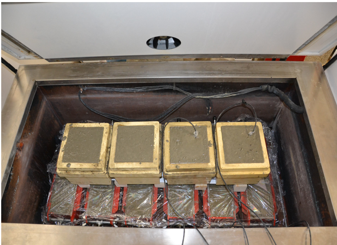
Obr. 5-4 Zkušební tělesa, uložená v chladicí skříni.
