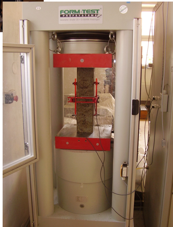
Obr. 5-7 Statická zatěžovací zkouška.
