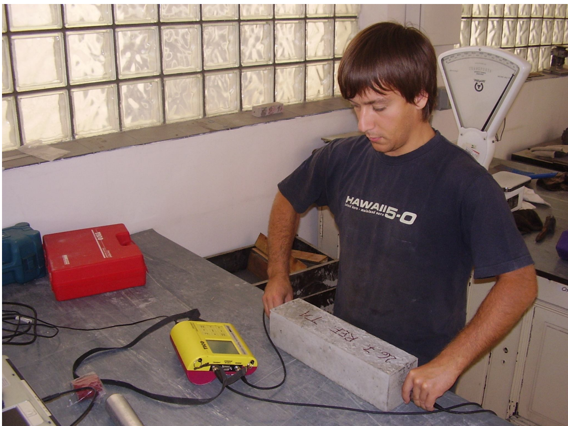
Obr. 5-5 Stanovení dynamického modulu pružnosti ultrazvukovou zkouškou.
