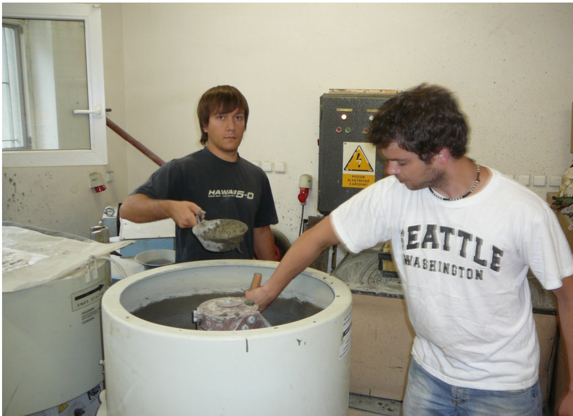
Obr. 5-3 Plnění forem betonem s následným vibrováním.
