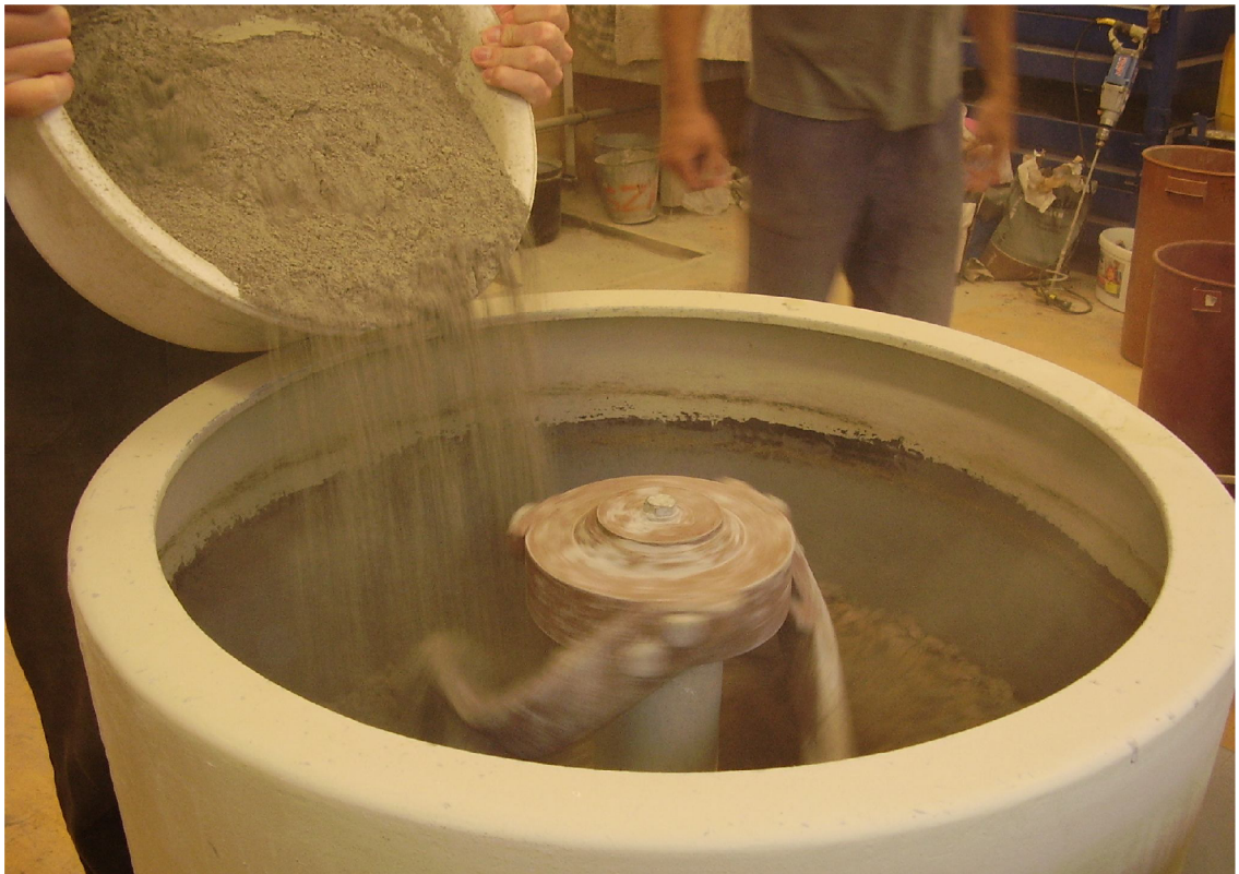
Obr. 5-1 Míchání betonu v laboratorní míchačce.
