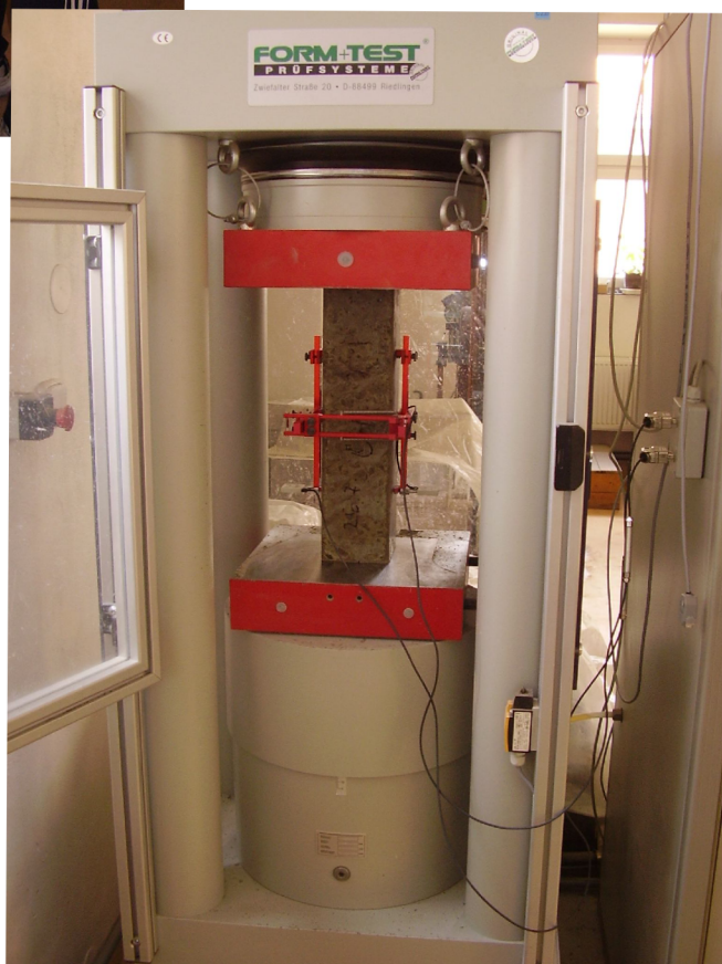
Obr. 5-7 Statická zatěžovací zkouška.
