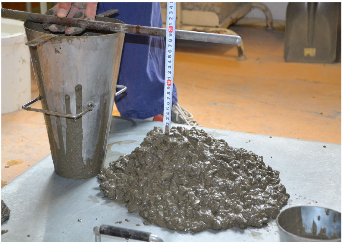
Obr. 5-2 Zkouška konzistence sednutím kužele.
