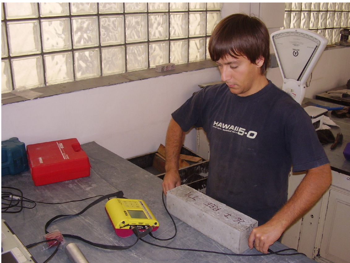
Obr. 5-5 Stanovení dynamického modulu pružnosti ultrazvukovou zkouškou.
