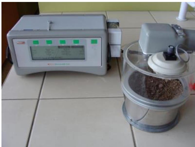
Obrázek 7 Systém LCi-SD portable photosynthesis s komorou pro měření půdní respirace
