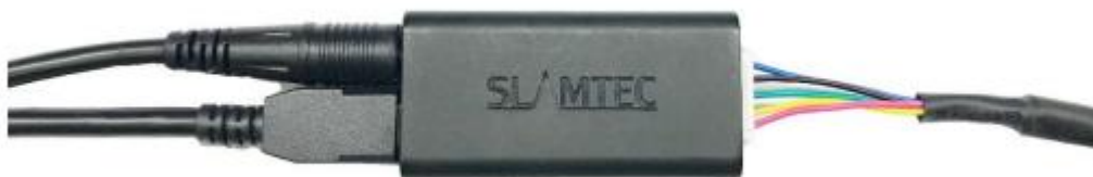
Obr. 9: Připojení RPLIDARu přes USB adaptér [14]
