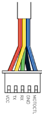
Obr. 8: Komunikační a napájecí rozhraní RPLIDAR [12]
