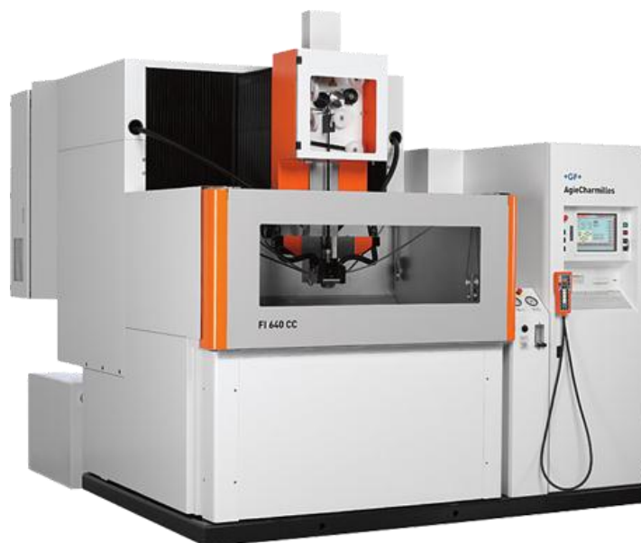
Obř. 4.4 Drátová řezačka s umělou inteligencí ROBOFIL 640 CC [22].
