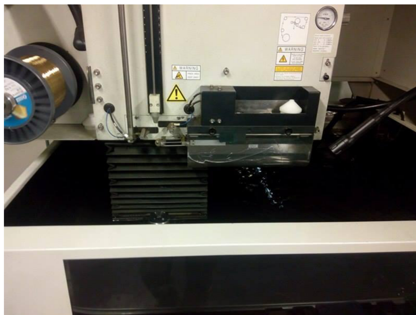
Obr. 4.6 Pracovní prostředí elektroerozivní řezačky – obrobek je ponořený v dielektriku (destilované vodě).
