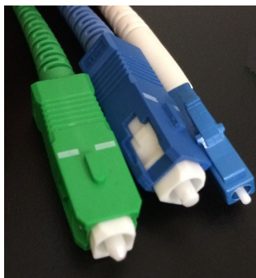
Obr. 1.7: Konektory – vlevo SC APC, uprostřed SC UPC, vpravo LC UPC
