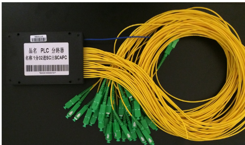
Obr. 1.6: Splitter PLC s dělicím poměrem 1:32
